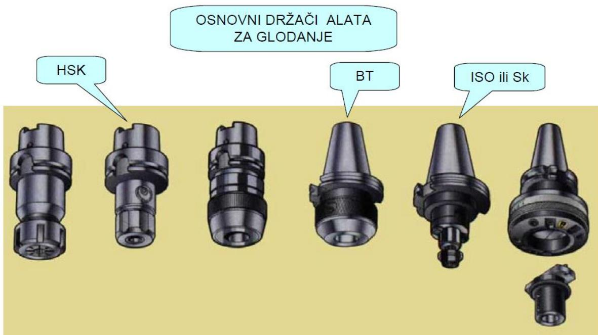
Slika 18. Osnovne vrste držača alata za glodanje [7]
