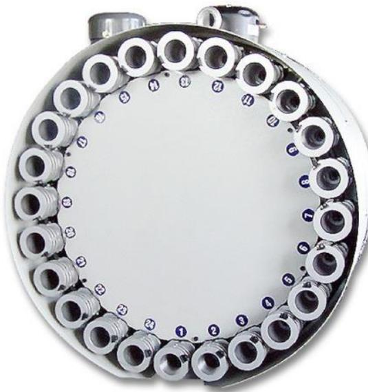
Slika 17. Disk magazin alata [15]
