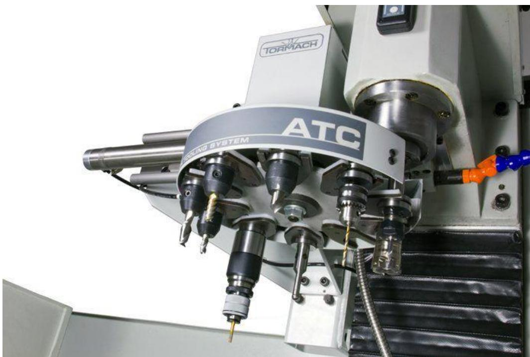
Slika 11. Automatski izmenjivač alata tvrtke TORMACH [9]
