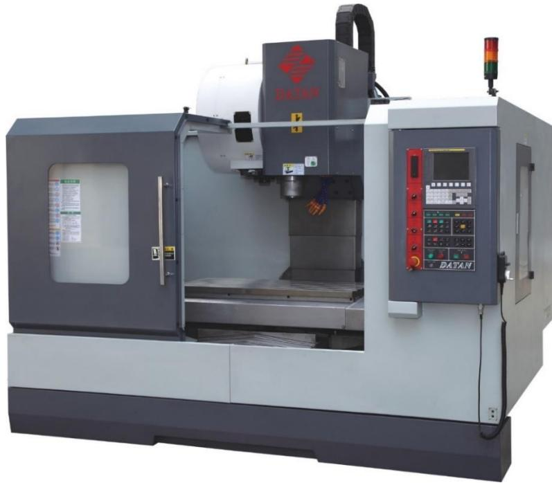
Slika 6. Vertikalni GOC tvrtke DATAN [5]
