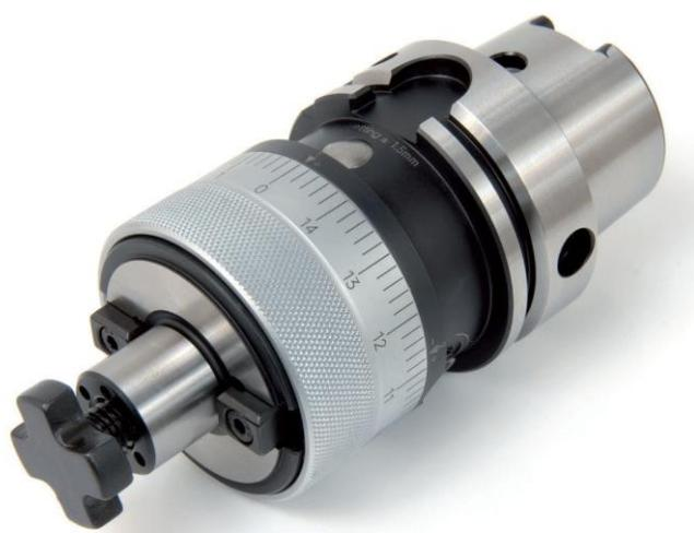
Slika 34. Stezni sustav za nasadna glodala [23]
