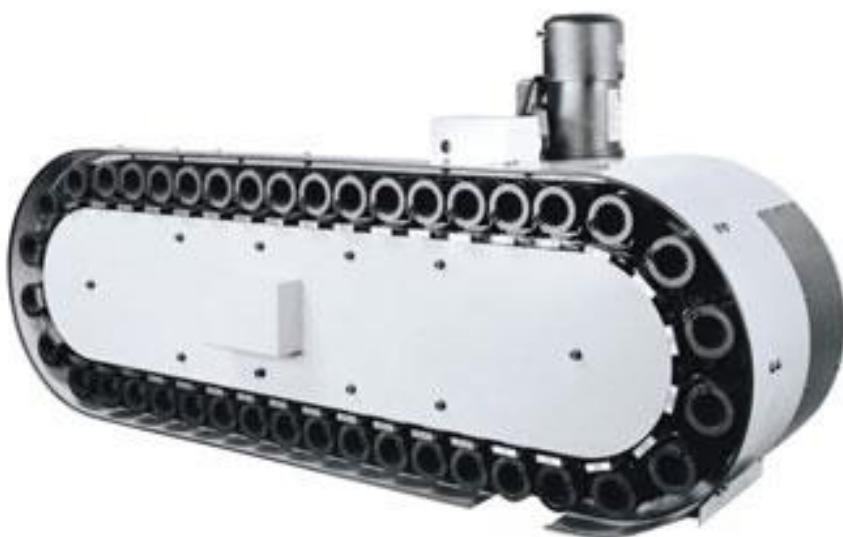
Slika 16. Lančani magazin alata [15]
