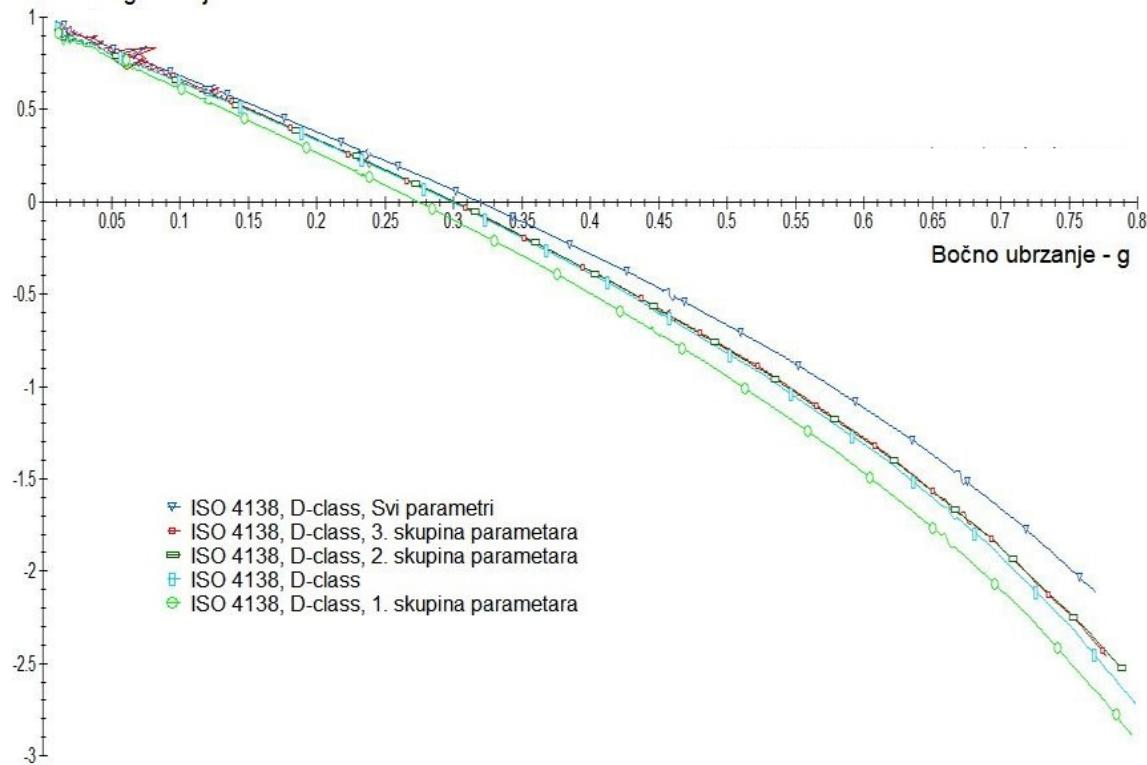
Slika 39. Kut bočnog klizanja vozila, FWD, poticanje podupravljenosti
