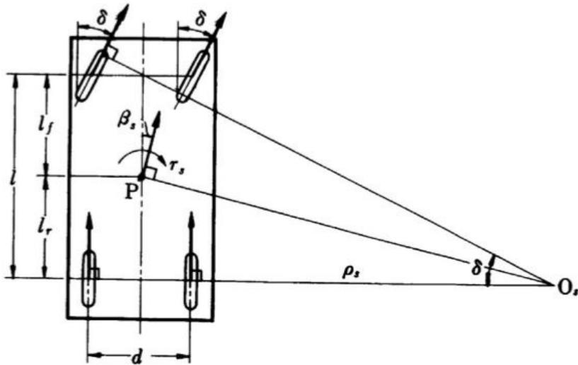
Slika 1. Kretanje vozila kroz zavoj malom brzinom [2]
