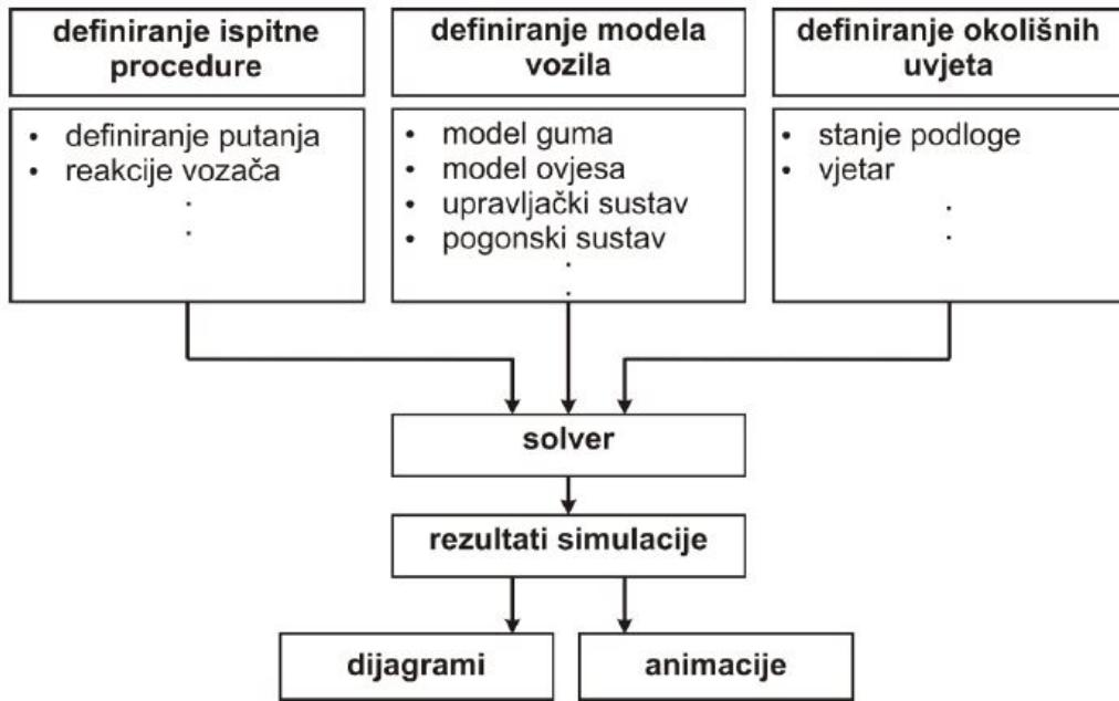
Slika 28. Princip rada CarSim-a [9]
