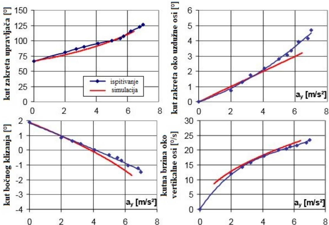
Slika 25. Rezultati ispitivanja i simulacija za Mercedes-Benz A-klasu [8]
