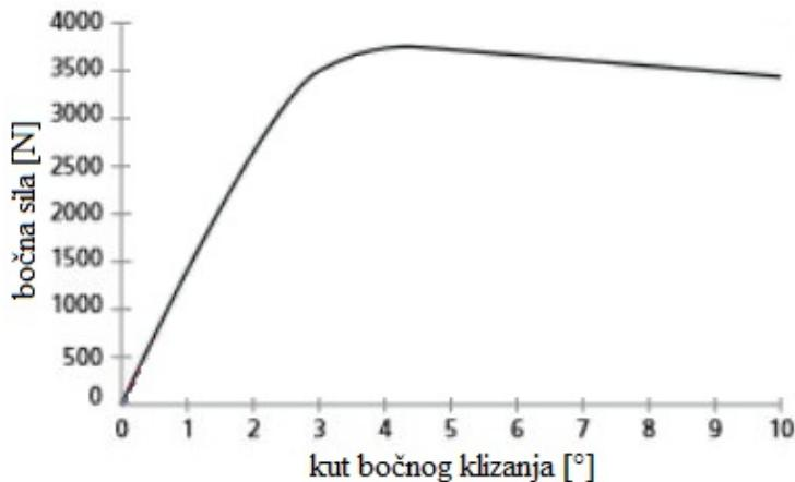
Slika 4. Ovisnost bočne sile o kutu bočnog klizanja [3]
