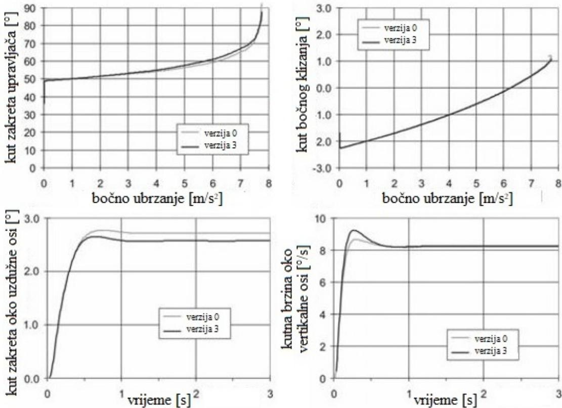
Slika 19. Rezultati simulacija s povišenom osi valjanja vozila [1]
