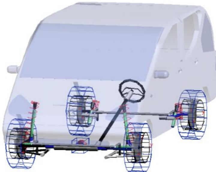
Slika 23. Simulacijski model za Mercedes-Benz A-klasu [11]
