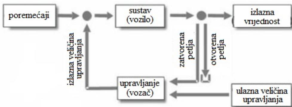
Slika 27. Shematski prikaz sustava otvorene i zatvorene petlje [1]
