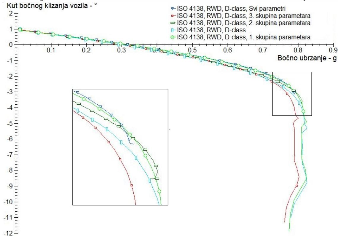
Slika 45. Kut bočnog klizanja vozila, RWD, poticanje podupravlјivosti
