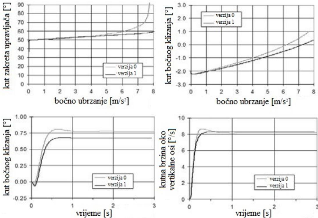
Slika 17. Rezultati simulacija sa sniženim težištem [1]
