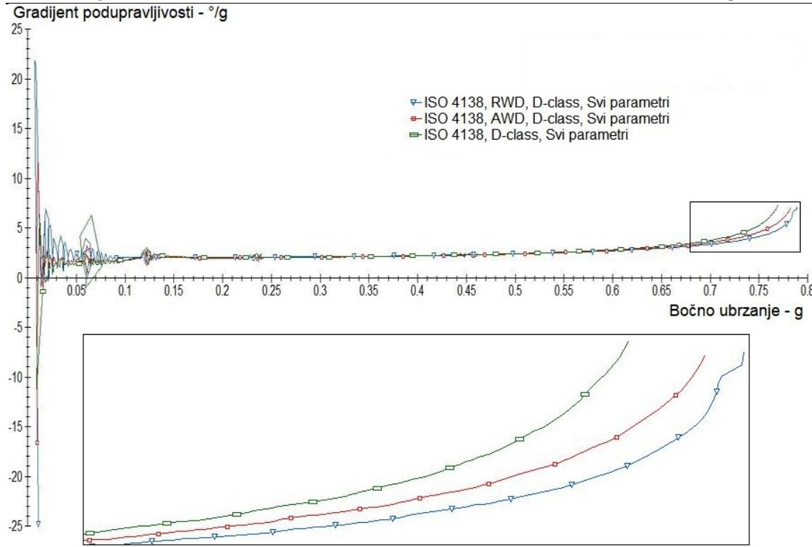
**Slika 55. Gradijent podupravljenosti, različite konfiguracije pogona, poticanje podupravljenosti**
