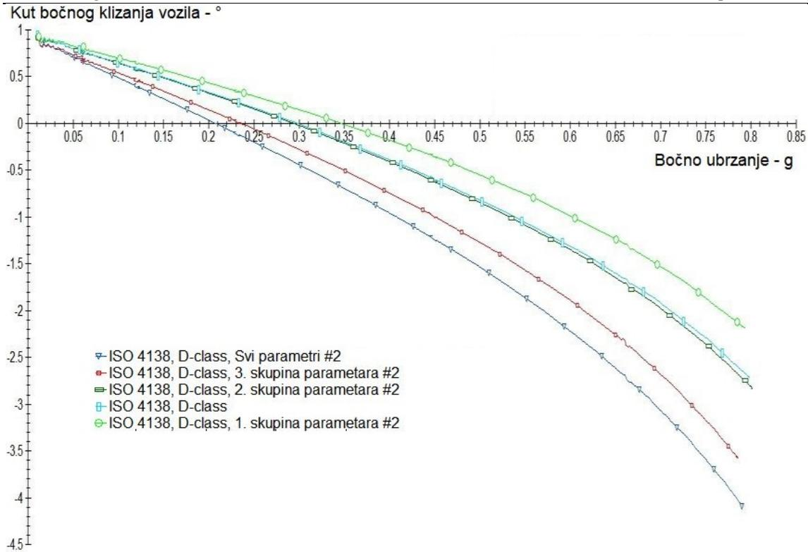
Slika 42. Kut bočnog klizanja vozila, FWD, poticanje preupravljivosti
