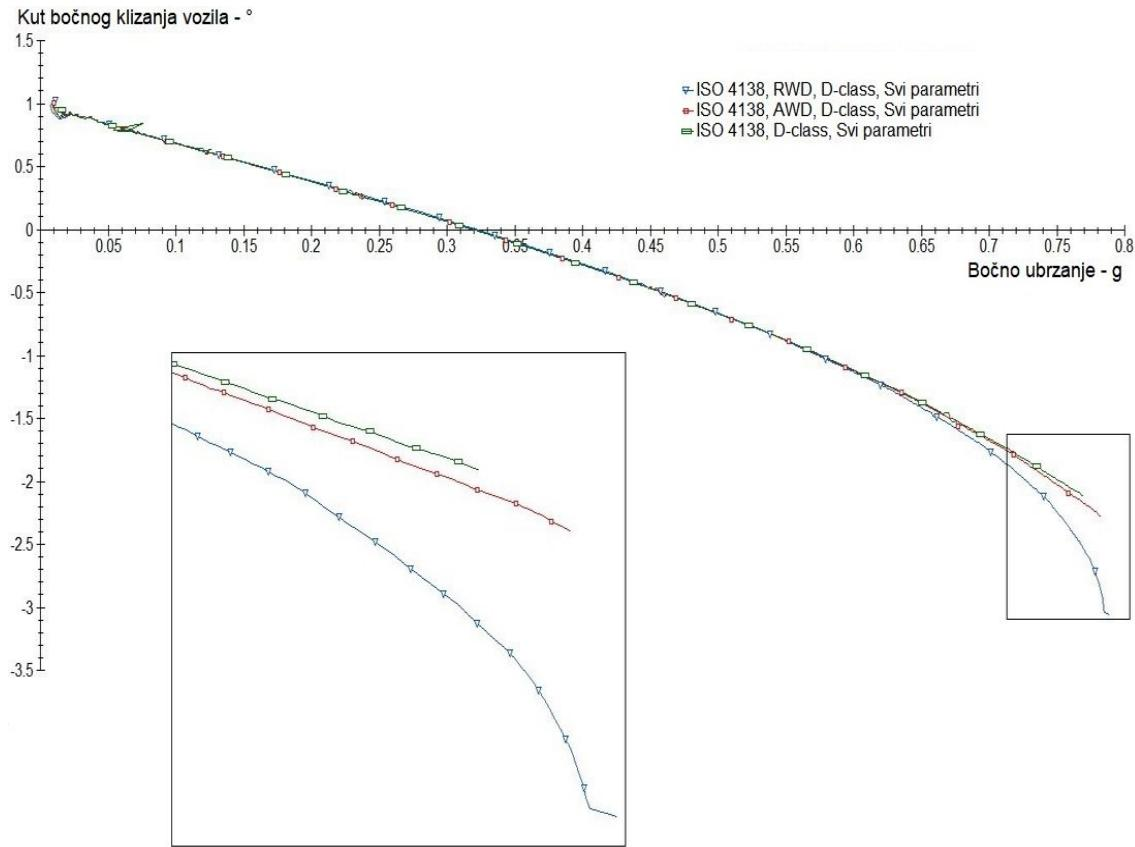
**Slika 54. Kut bočnog klizanja vozila, različite konfiguracije pogona, poticanje podupravlјivosti**
