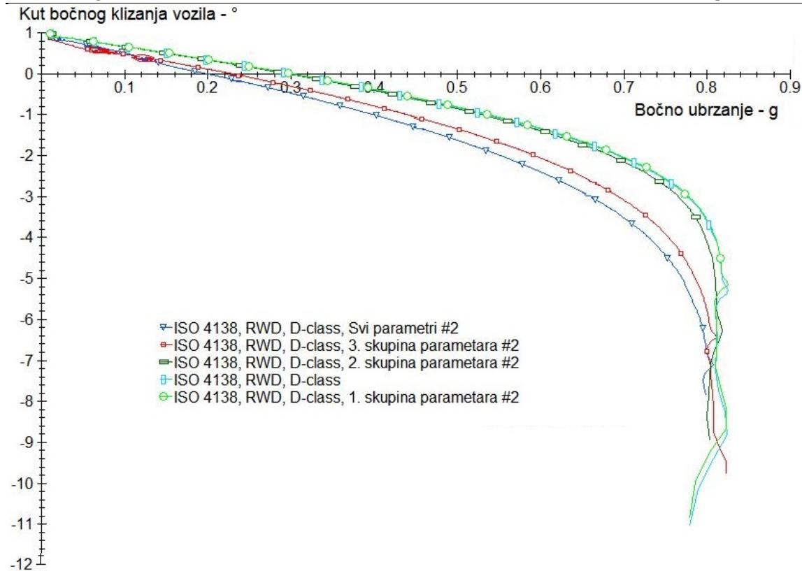
Slika 49. Kut bočnog klizanja vozila, RWD, poticanje preupravljivosti
