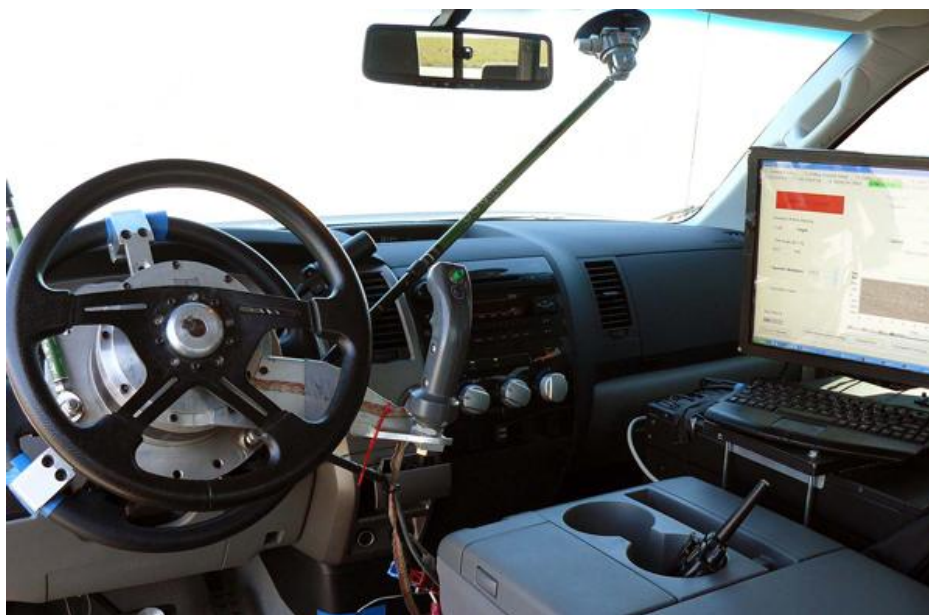
Slika 9. Uređaj za robotizirano upravljanje upravljačem
