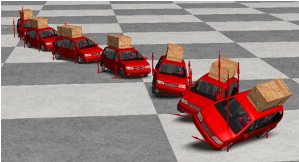
Slika 105. Animacija prevrtanja vozila, Fishhook, teret na krovu
