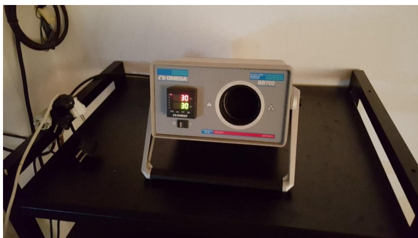
Slika 8. Kalibracijsko crno tijelo „Omega BB702“
