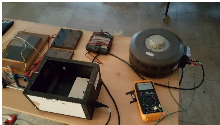
Slika 20. Mjerna linija s električnom grijalicom
