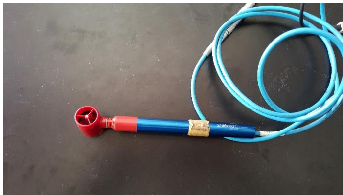
Slika 27. Anemometar s rotirajućim vrhom
