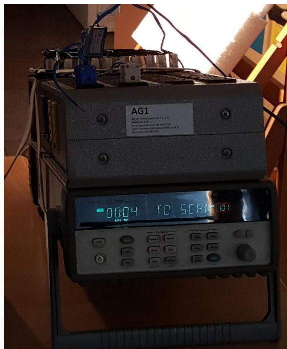
Slika 9. Analogno-digitalni pretvarač signala
