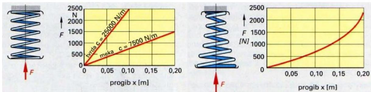
Slika 28. Linearna (lijevo) i progresivna (desno) karakteristika [4]
