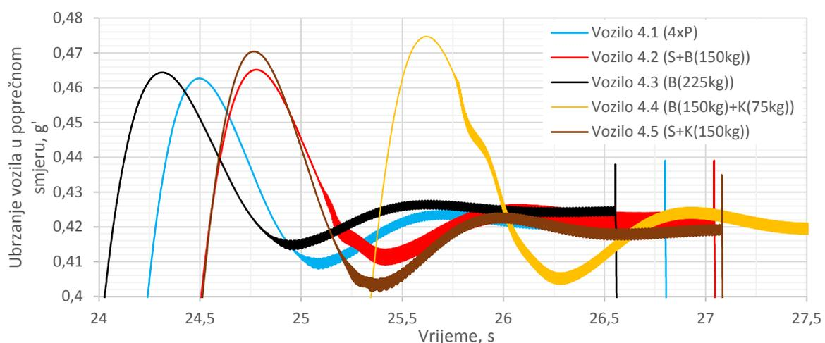
**Slika 74. Oscilacije ubrzanja u poprečnom smjeru pri ustaljenom stanju**
