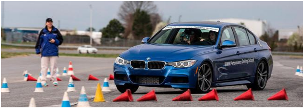
Slika 9. Automobil na poligonu tijekom provedbe procedure dvostruke promjena pravca gibanja [11]
