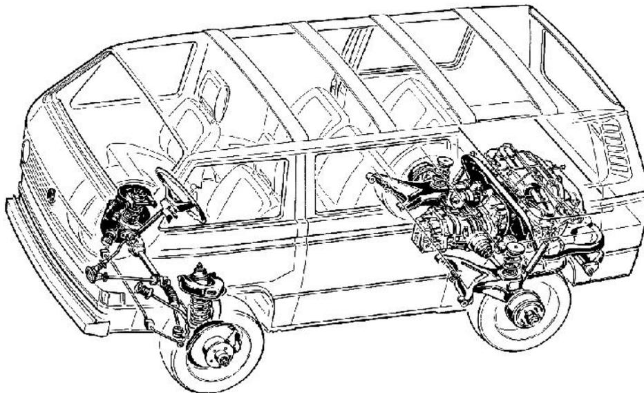
Slika 26. VW Transporter, stražnji pogon s motorom postavljenim straga [7]
