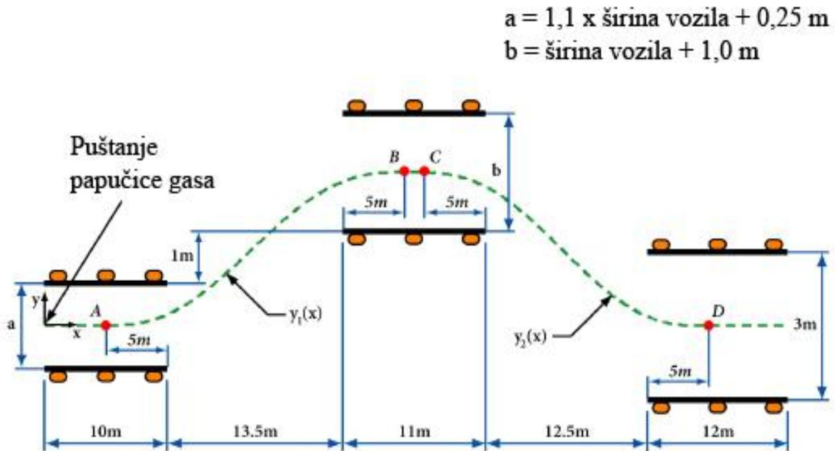
Slika 11. Ispitna staza za provedbu procedure izbjegavanja prepreke [15]
