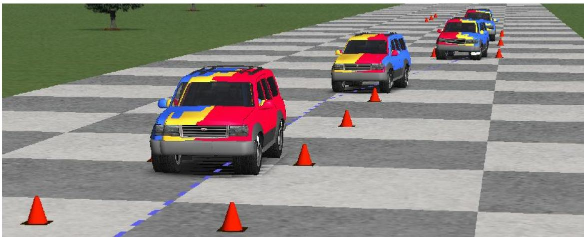
Slika 48. Simulacija ispitne procedure ISO 3888-1:1999
