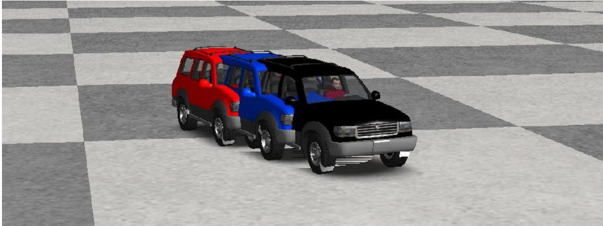
Slika 69. Simulacija ispitne procedure ISO 7401:2011
