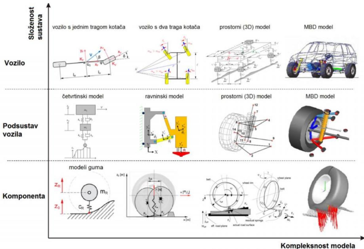
Slika 19. Usporedba kompleksnosti pojedinih simulacijskih modela [25]
