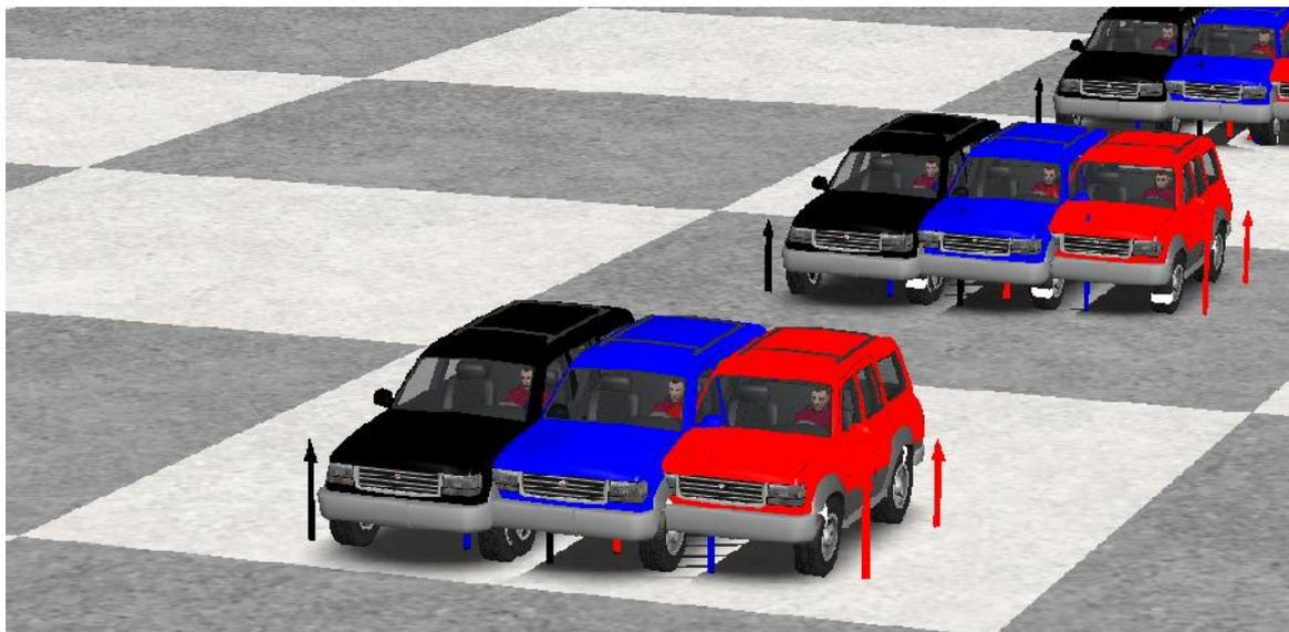
Slika 75. Simulacija ispitne procedure ISO 13674-1:2010 Test krivudanjem
