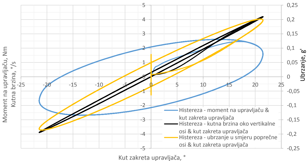
Slika 78. Primjer 1 - histereza za izvorno vozilo
