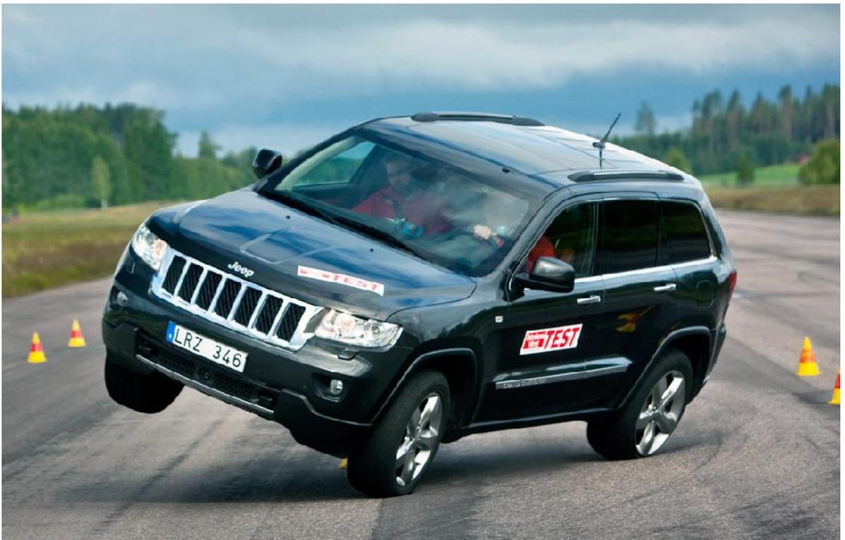
Slika 8. Izvođenje ispitne procedure ISO 3888-2 [10]
