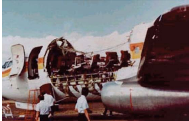
Slika 2.1-9 Oštećenje na Aloha Airlines 737 [6]
