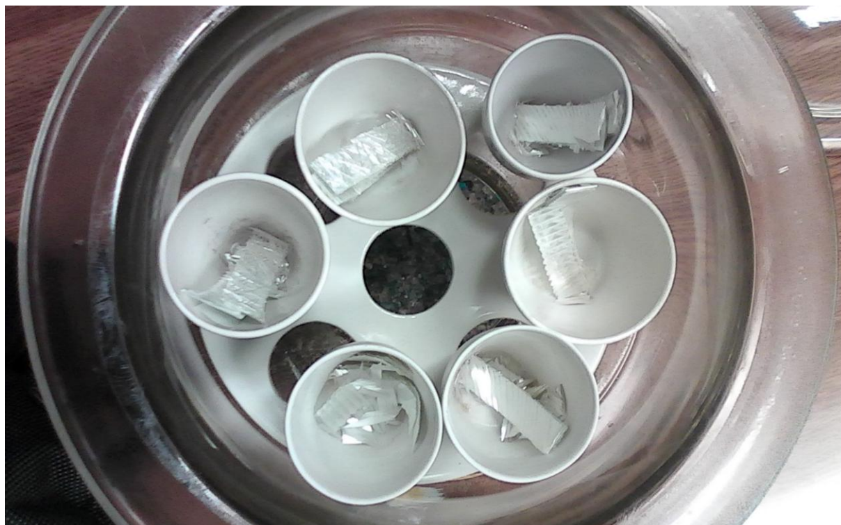
Slika 6.18. Ispitna tijela nakon postupka žarenja
