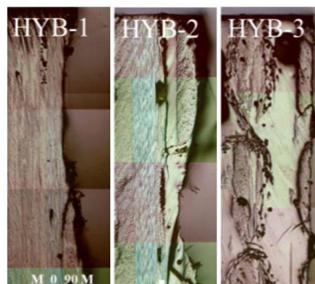
b) ispitna tijela za ispitivanje smične čvrstoće
