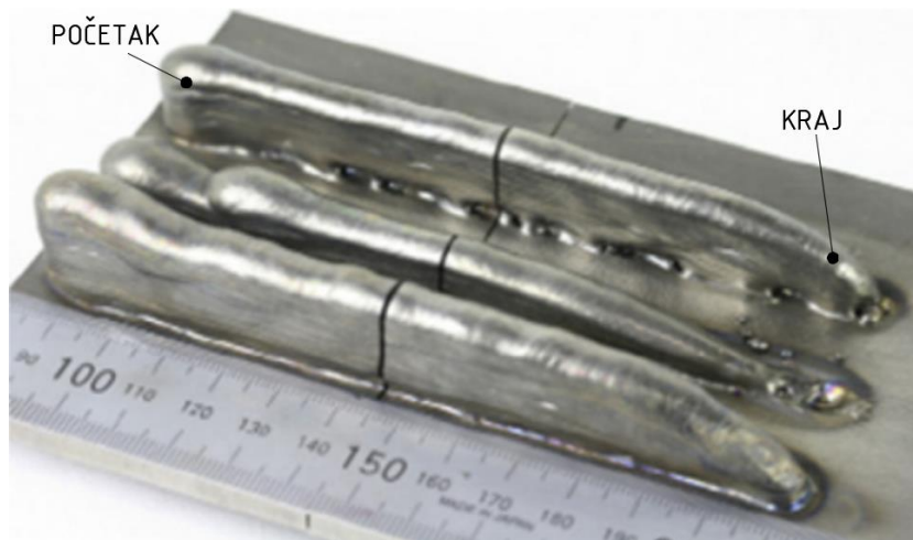
Slika 30. Razlika u geometriji zavara na početku i na kraju prolaza [6]
