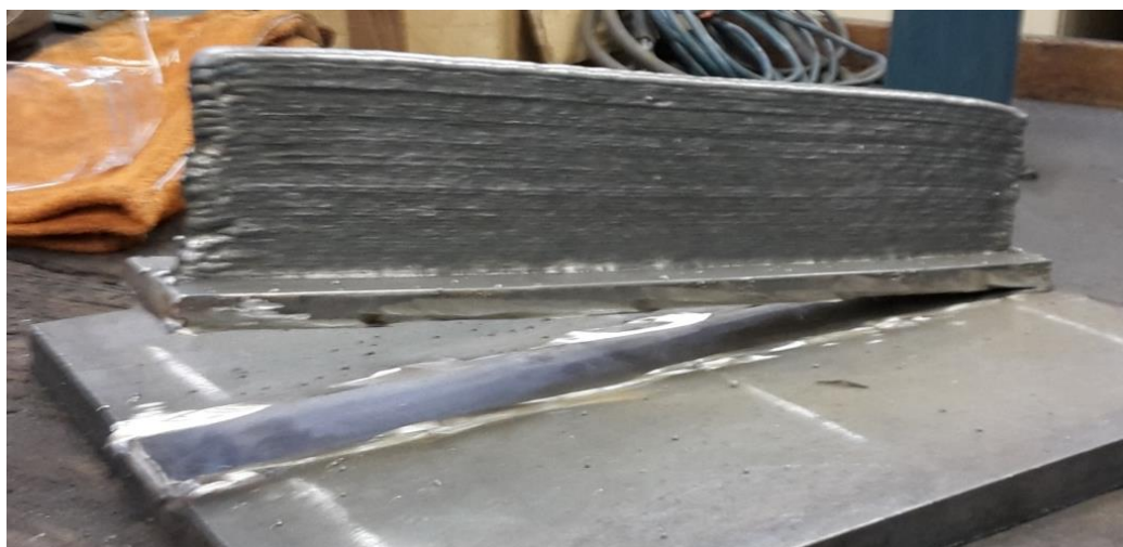
Slika 50. Uklanjanje podložne ploče
