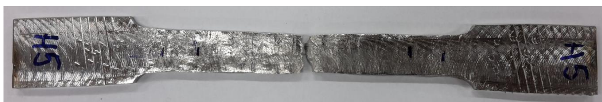
Slika 68. Epruveta uzorka 2 nakon ispitivanja
