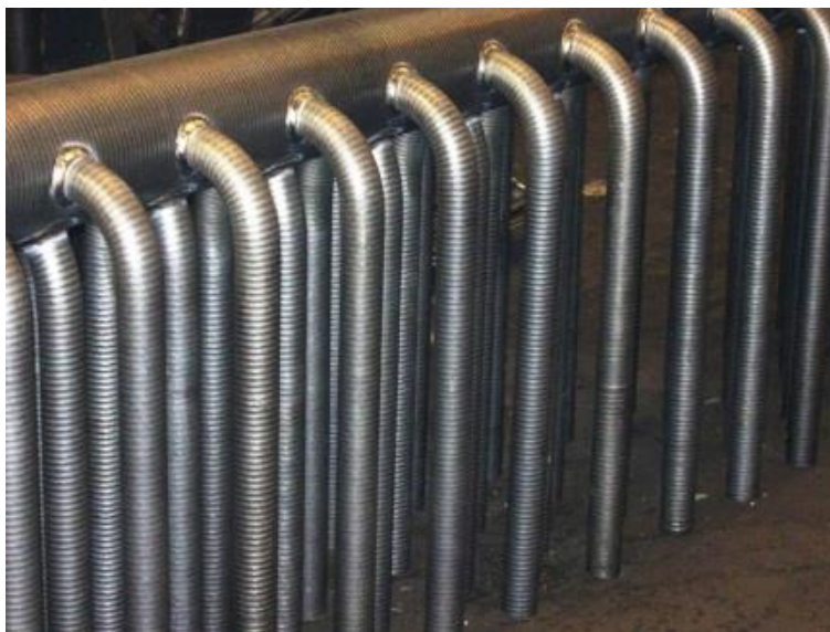
Slika 39. Kotlovske cijevi obložene Inconelom 625 [33]
