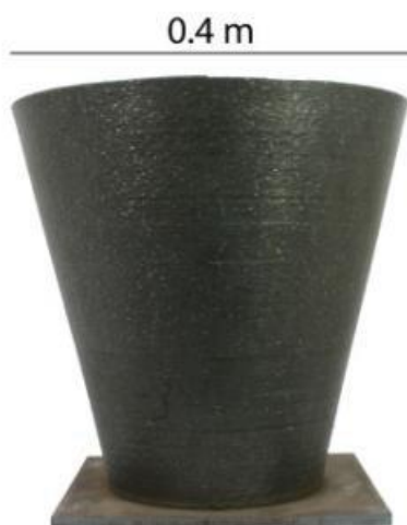
Slika 14. Čelični stožac izrađen WAAM postupkom [9]
