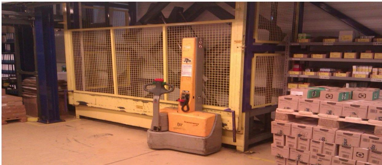
**Slika 3.20. Hidraulična škarasta platforma**
