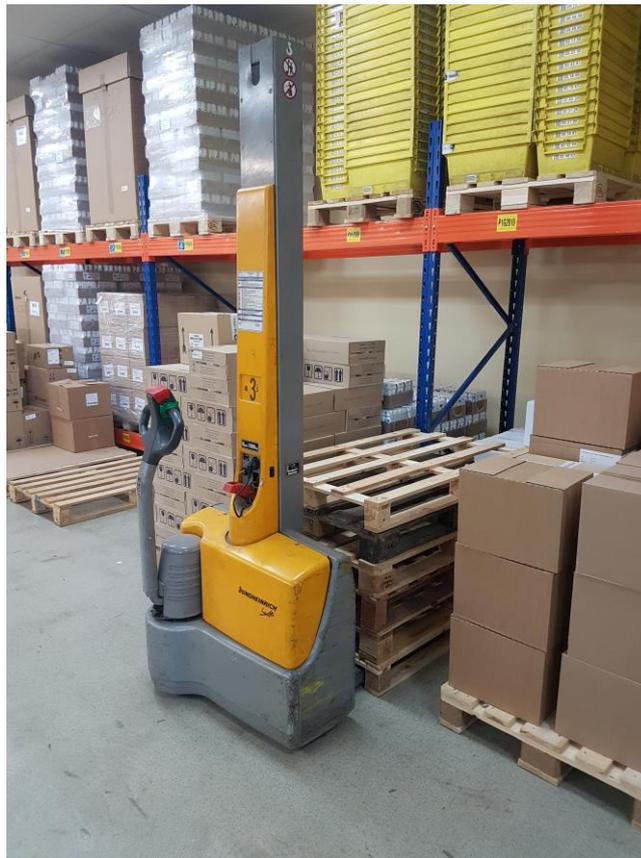
**Slika 3.17. Električni visokopodizni viličar EMC 110**
