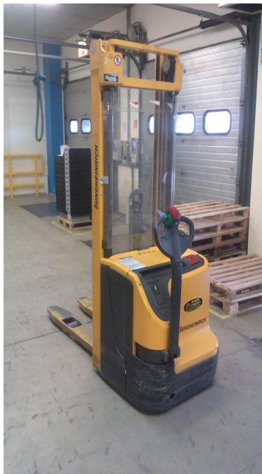
**Slika 3.16. Električni visokopodizni viličar**
