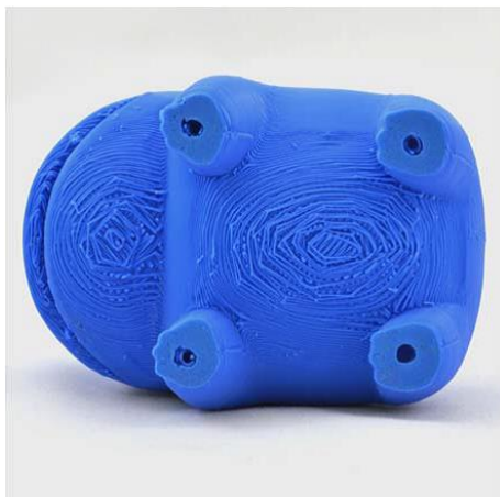
Slika 3.33. Loša površina proizvoda iznad podupora [12]
