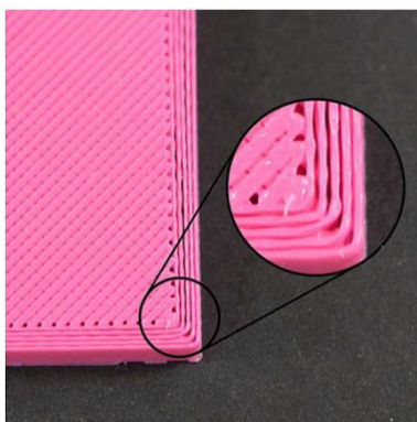
Slika 3.12. Nedovoljno ekstrudiranje materijala [12]
