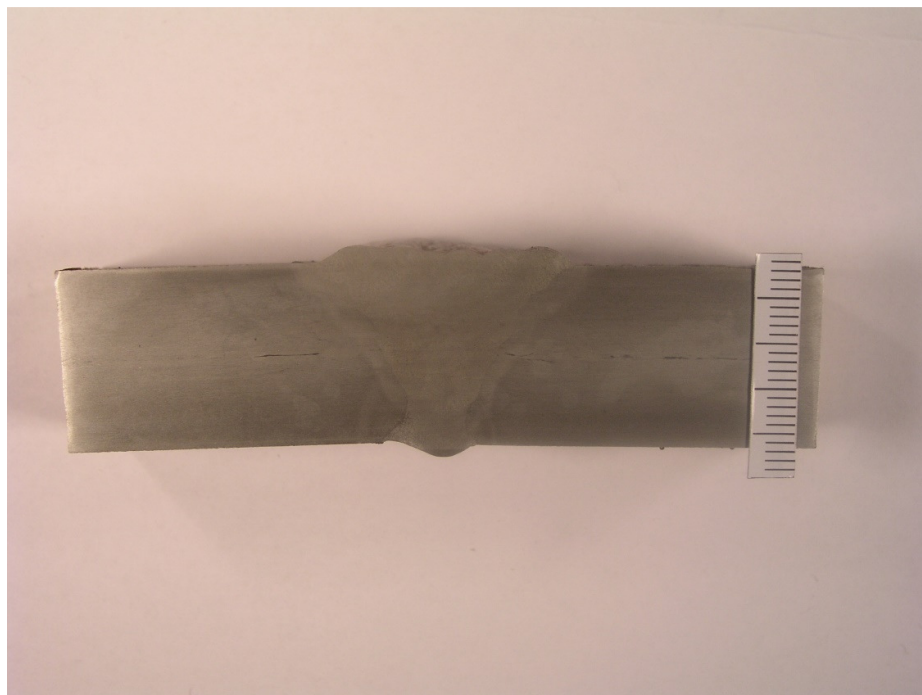
Slika 28. Uzorak nakon nagrižanja
