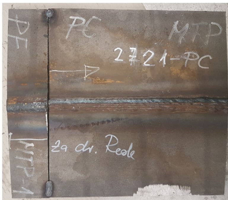
Slika 13. Zavarena ploča od čelika S355J0WP – tjemena zavora
