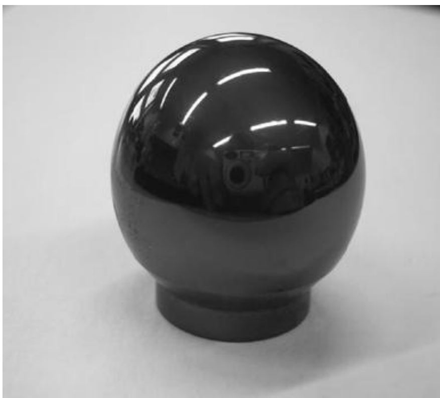
Slika 14. DLC prevlaka na zglobnom implantatu [32]
