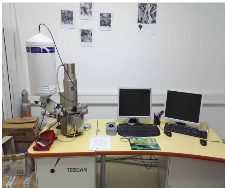
Slika 32. Skenirajući elektronski mikroskop (SEM) Tescan Vega TS5136LS [56]
