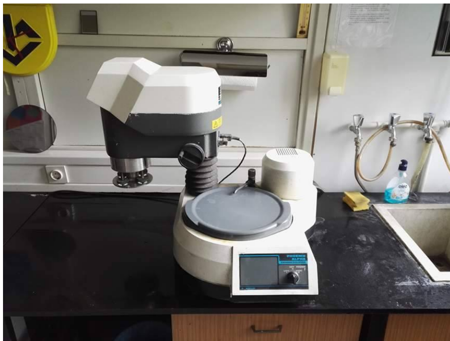
Slika 35. Buehler Phoenix Alpha uređaj za poliranje [56]
