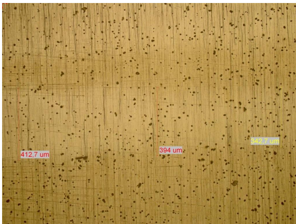
Slika 47. Trag trošenja snimljen na svjetlosnom mikroskopu (povećanje 100x): a) neprevučeni uzorak A0 b) uzorak TiN
