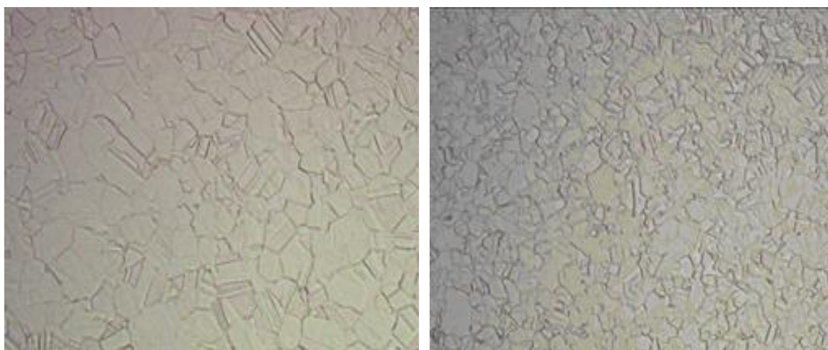
Slika 10. Mikrostruktura toplo oblikovane ASTM F 1537 legure proizvedene a) konvencionalnim postupkom i b) postupkom metalurgije praha [25]
