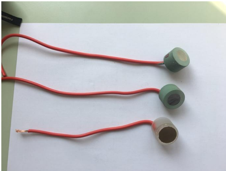
Slika 38. Uzorci pripremljeni za elektrokemijska ispitivanja [56]
