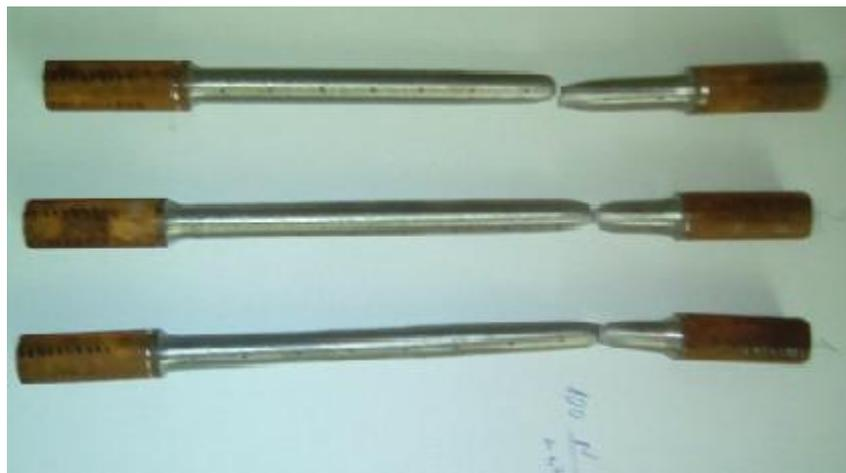
**Slika 16** Epruvete nakon ispitivanja pri brzini prirasta opterećenja  $100 \text{ N/mm}^2 \cdot \text{s}^{-1}$
