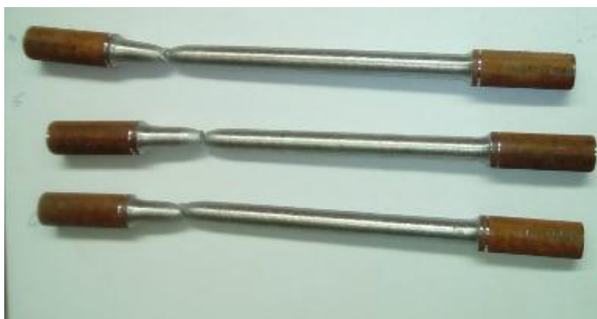
Slika 15 Epruvete nakon ispitivanja pri brzini prirasta opterećenja 50 \text{ N/mm}^2 \cdot \text{s}^{-1}
