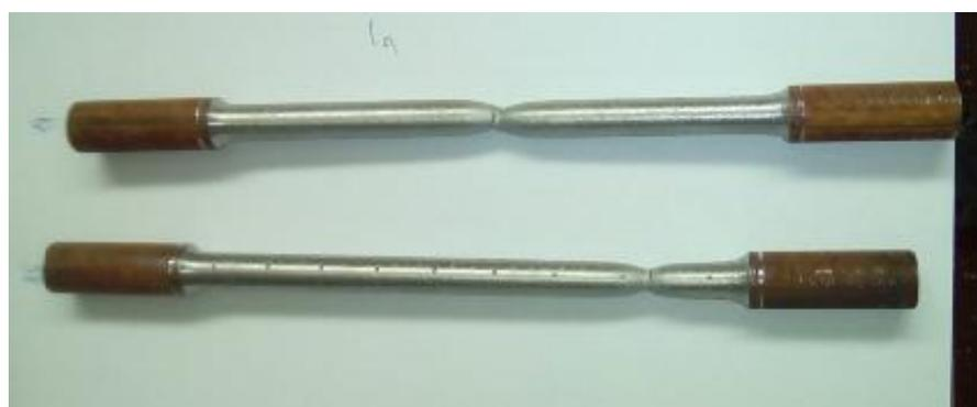
Slika 11 Epruvete nakon ispitivanja pri brzini prirasta opterećenja  $5 \text{ N/mm}^2 \cdot \text{s}^{-1}$
