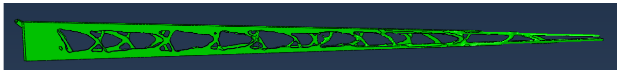
Slika 73. Izgled optimiranog malog kutijastog nosača sa maksimalno 16% volumena
