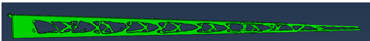
Slika 71. Izgled optimiranog kutijastog nosača sa maksimalno 25% volumena
