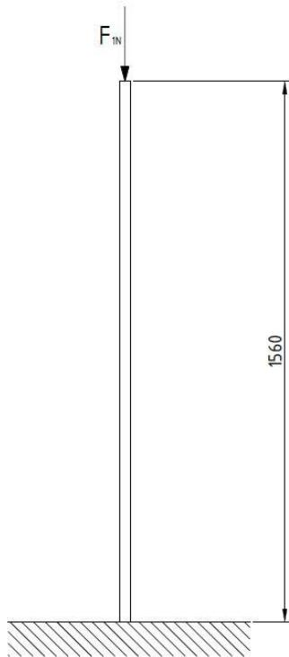
**Slika 32. Izvijanje nosača**
