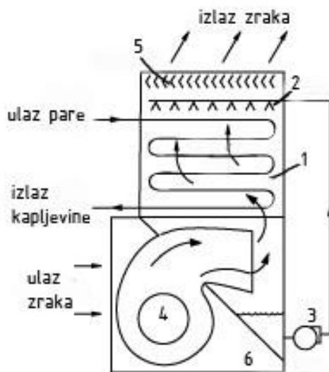
Slika 1. Skica evaporativnog kondenzatora
