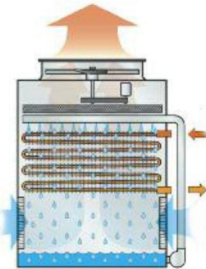
**Slika 2. Aksijalni ventilator na vrhu [1]**
