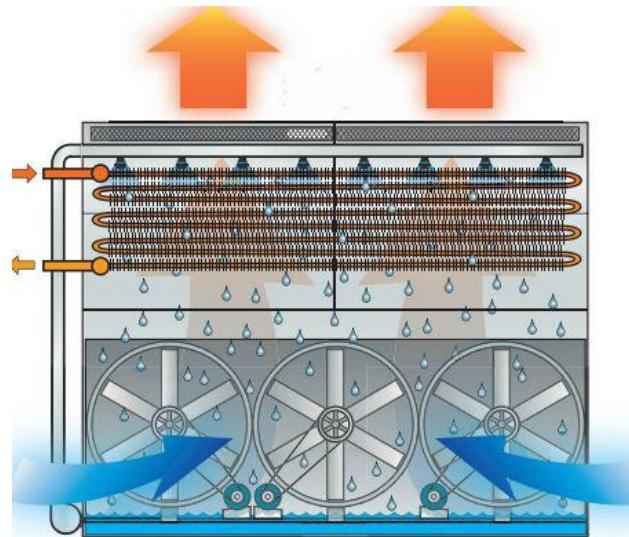
**Slika 3. Aksijalni ventilator na dnu [1]**
