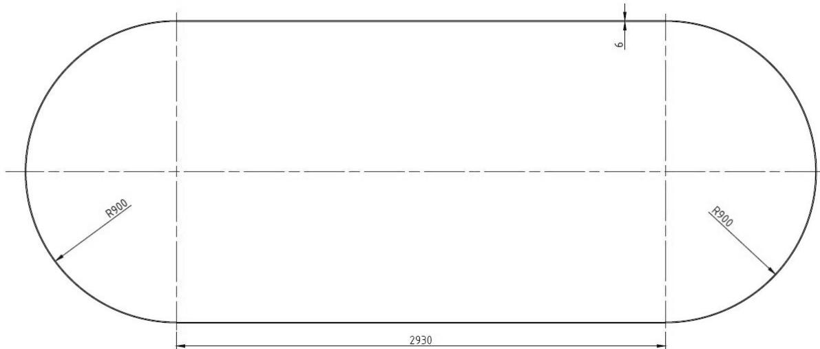
Slika 24. Dimenzije kućišta
