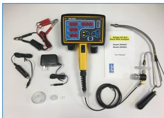
Slika 13. Prijenosni uređaj za mjerenje sastava ispušnih plinova
