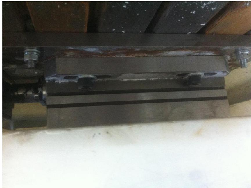
Slika 33. Postavljeni senzor sila
