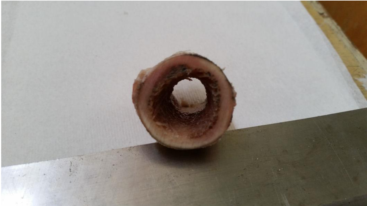
Slika 24. Poprečni presjek koštanog uzorka
