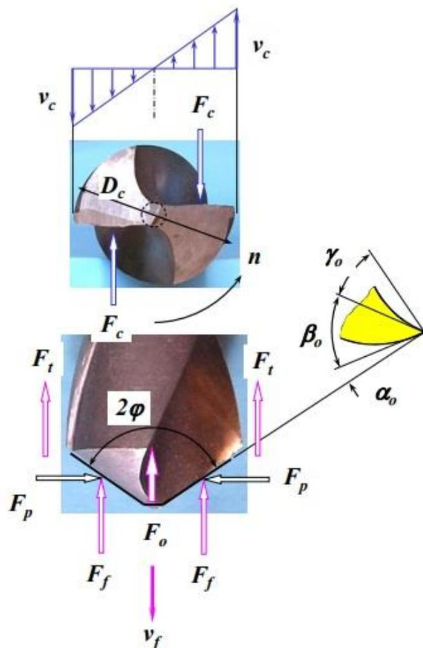
Slika 18. Parametri bušenja [2]
