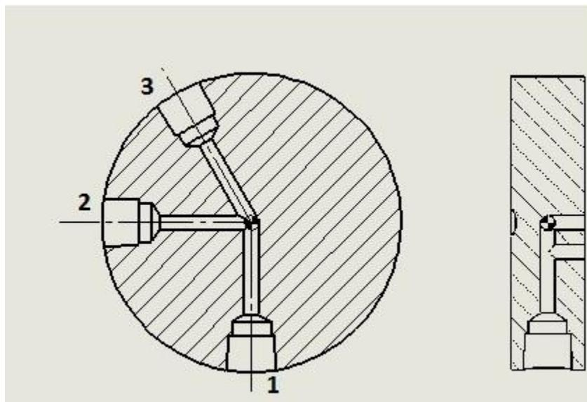
Slika 35. Porečni presjek kružne ploče s kanalima
