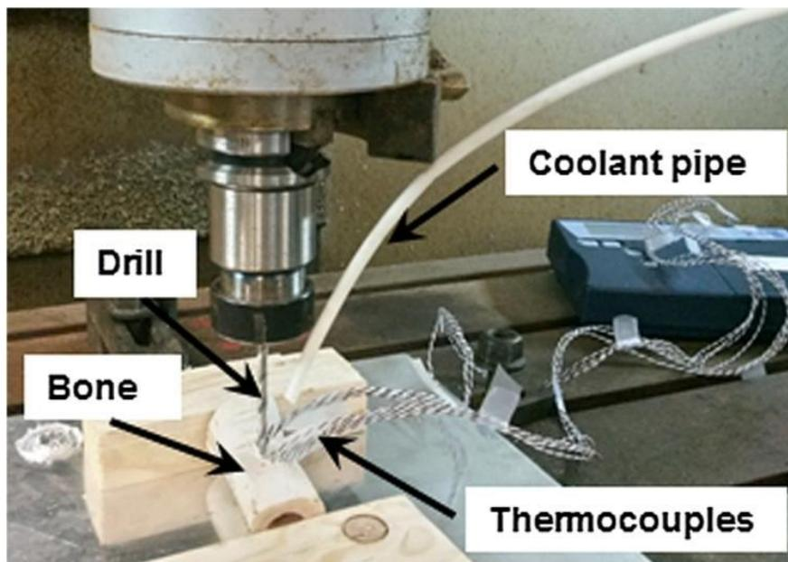
Slika 25. Ispitivanje bušenja kosti uz mjerila za temperaturu [17]
