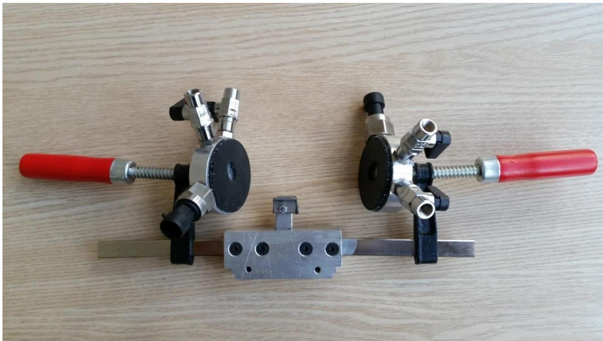
**Slika 27. Naprava za prihvat koštanog uzorka**
