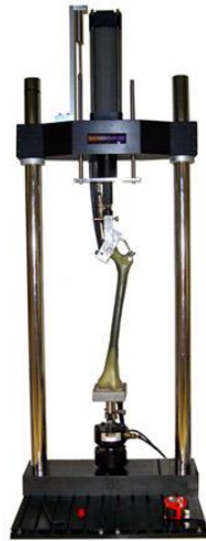
Slika 10. Vlačno ispitivanje kosti [13]
