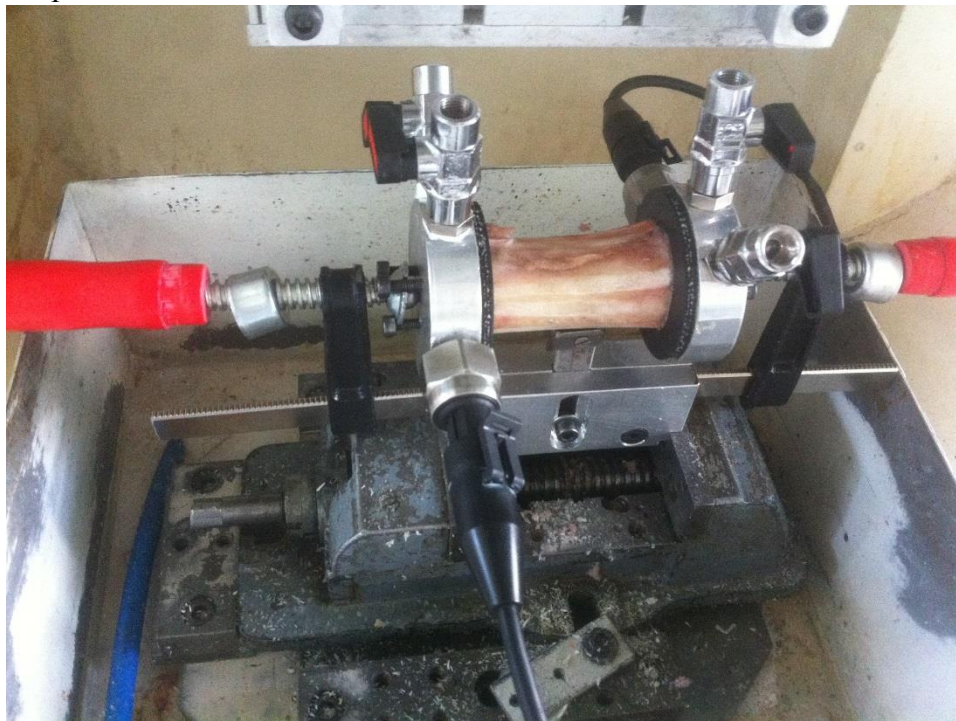
Slika 31. Naprava učvršćena na škripac
