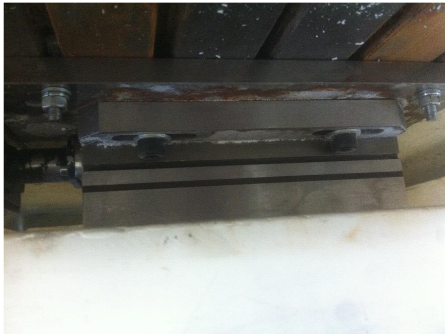
Slika 33. Postavljeni senzor sila
