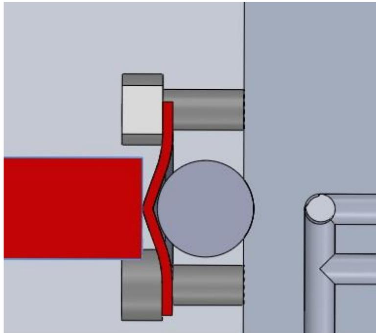
Slika 29. Spoj između stezaljke i kružne ploče (Solidworks)
