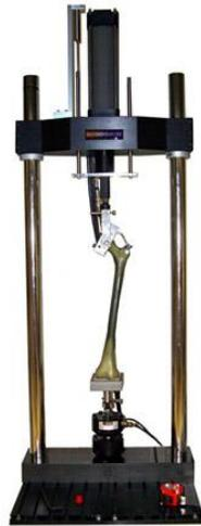
Slika 10. Vlačno ispitivanje kosti [13]
