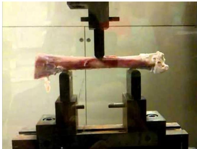
Slika 11. Test savijanja u tri točke [14]
