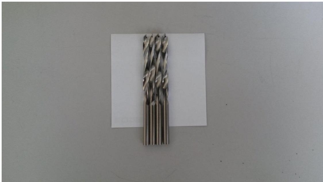
Slika 21. Svrdlo s kanalom za protočno hlađenje
