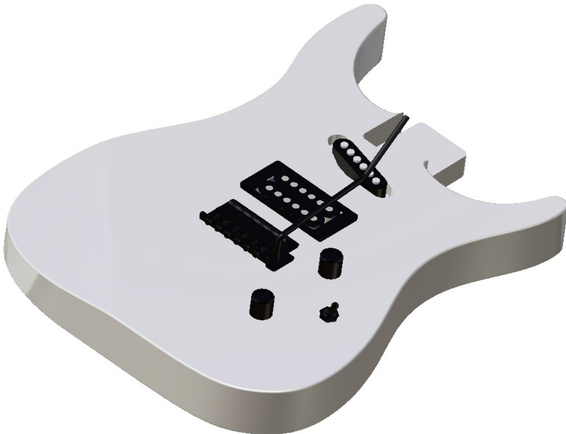
Slika 25. Tremolo na 3D modelu tijela gitare
