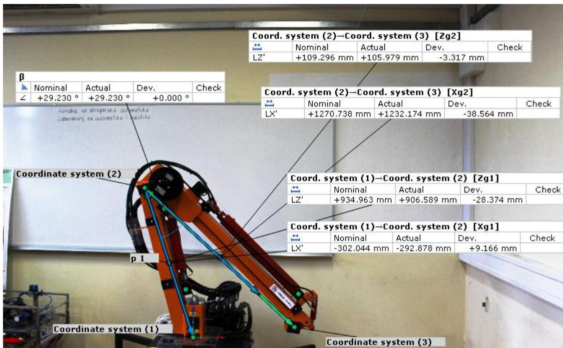
Slika 22. Izmjerene vrijednosti u poziciji minimalnih promjenjivih vrijednosti
