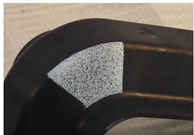
**Slika 6.** Priprema mernog objekta nanošenjem teksture [5]
