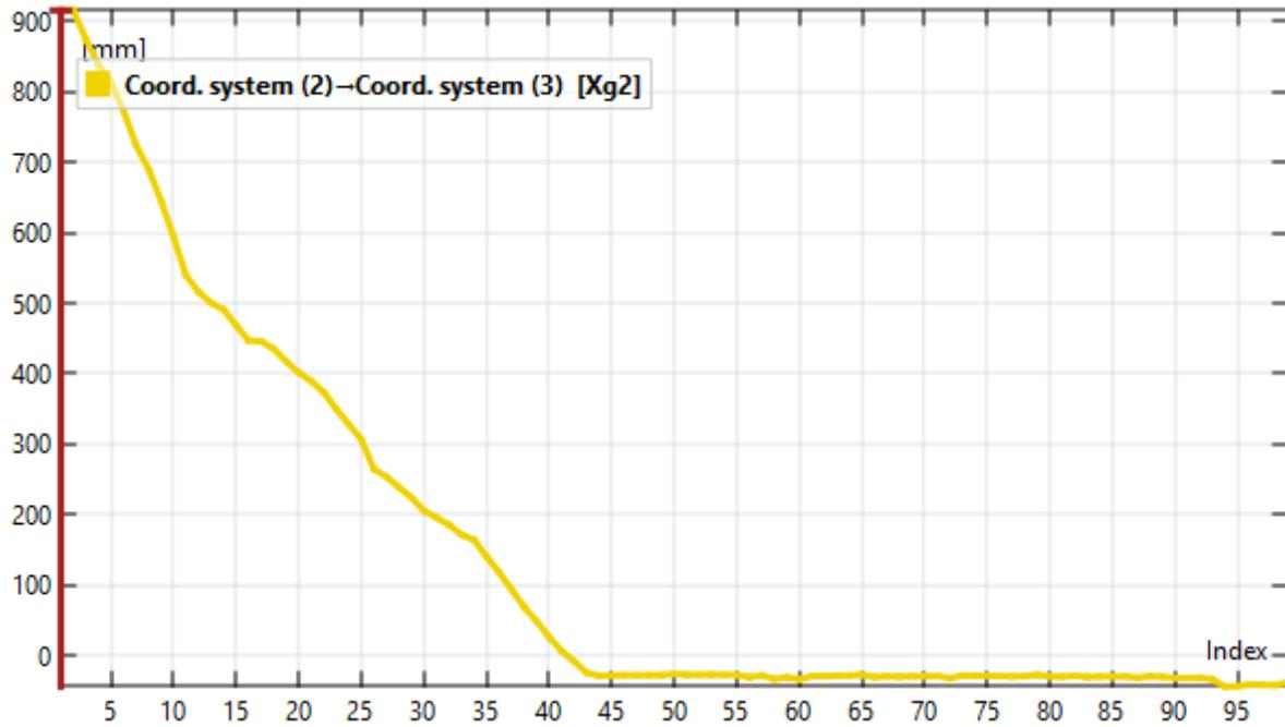
Slika 21. Produljenje teleskopske grede za iznos  $x_T$
