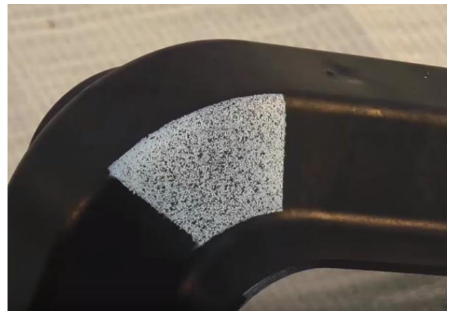
Slika 6. Priprema mjernog objekta nanošenjem teksture [5]
