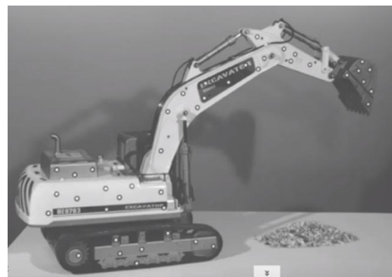
Slika 8. Pripremljeni mjerni objekt s referentnim markerima [6]
