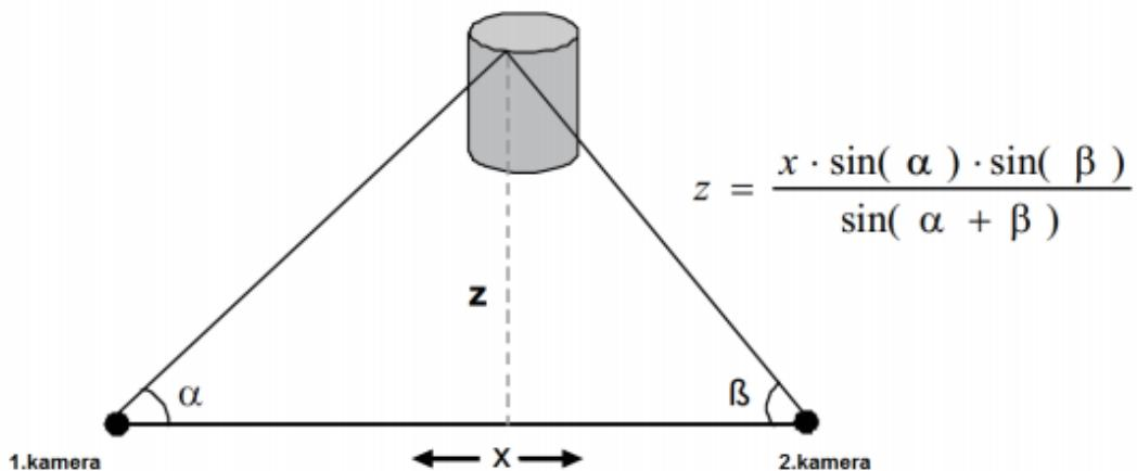
**Slika 3. Princip triangulacije [4]**
