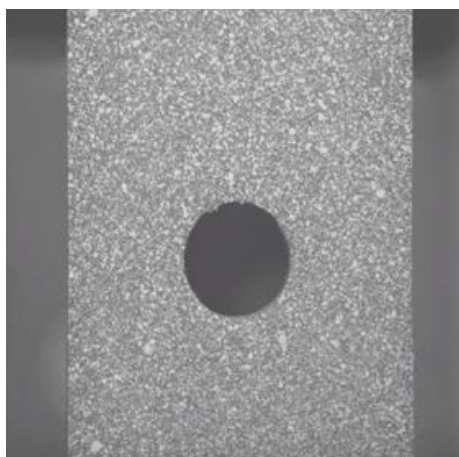
Slika 5. Valjana prirodna struktura mjernog objekta [5]
