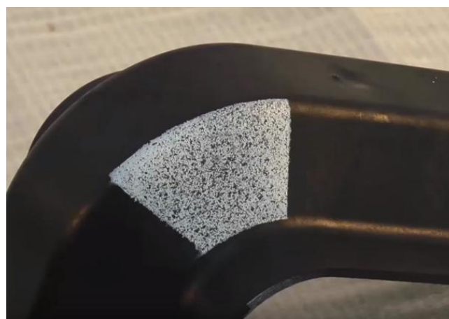
Slika 6. Priprema mjernog objekta nanošenjem teksture [5]
