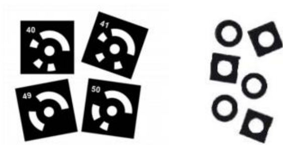
Slika 7. Mjerne točke (markeri), kodirane i nekodirane [7]
