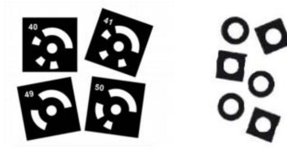
**Slika 7.** Mjerne točke (markeri), kodirane i nekodirane [7]
