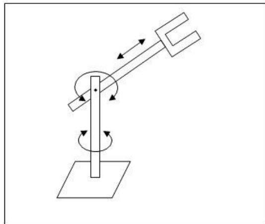
**Slika 2. Sferna konfiguracija robota**
