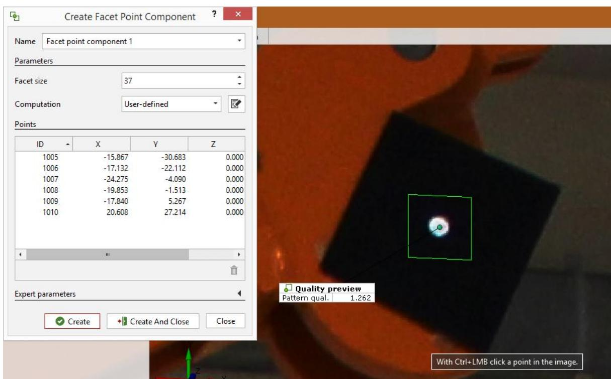
Slika 16. Pridruživanje Facet Point Componenta točkama na objektu
