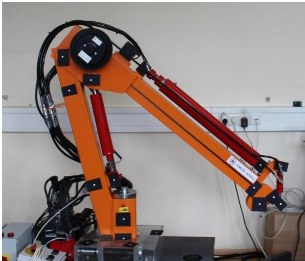
**Slika 12.** Robotski manipulator nakon pripreme za mjerjenje
