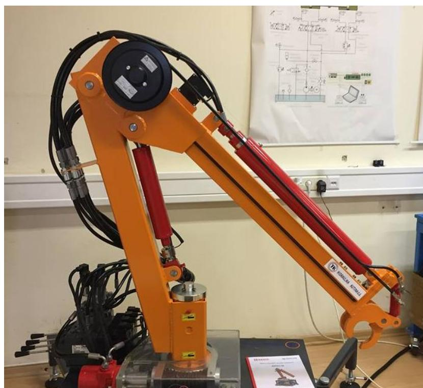
Slika 1. Elektrohidraulički robotski manipulator
