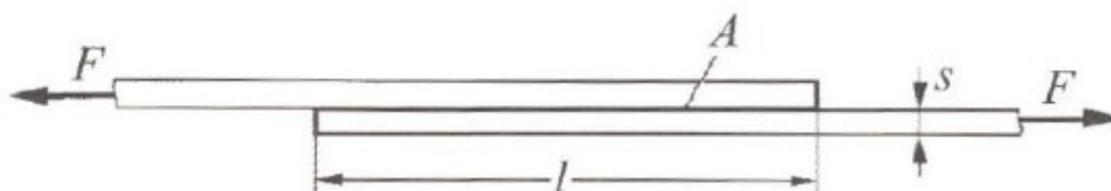
Slika 14. Smično opterećeni jednostruki preklopni spoj, A – površina lijepljenog spoja, l – duljina, s – debljina lima, F – sila kojom se opterećuje spoj [7]
