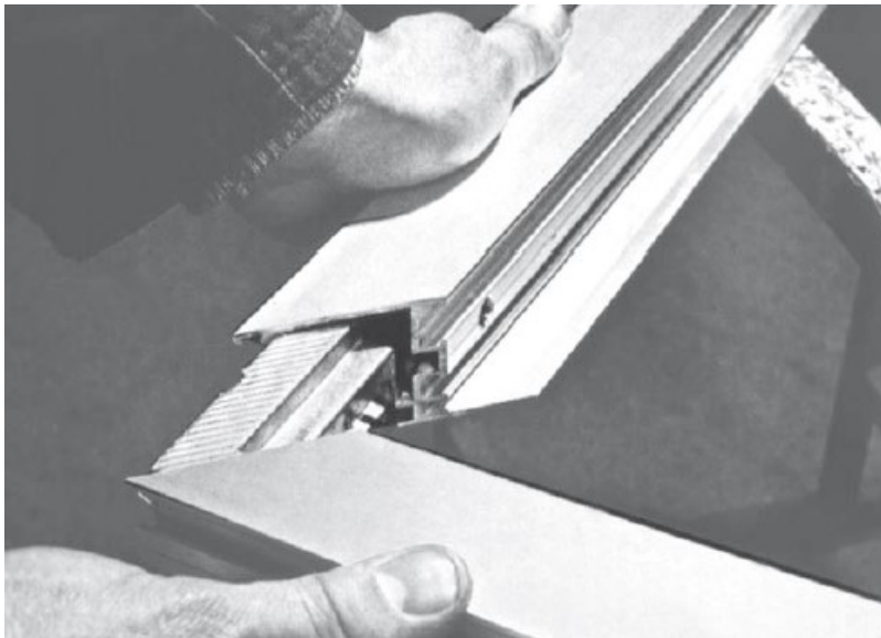
Slika 19. Spajanje aluminijskih okvira tehnologijom lijepljenja [24]
