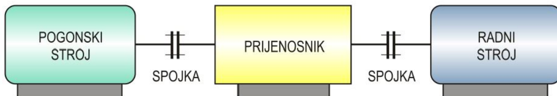
Slika 1.1: Shematski prikaz mehaničkog sustava sa spojkom [9]
