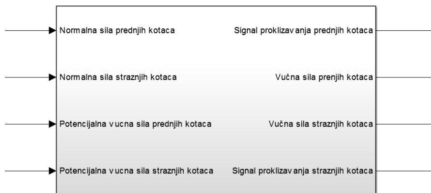
Slika 26. Reducirani blok proklizavanja guma (Simulink)
