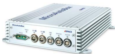
Slika 8. Upravljačka jedinica dSpace MicroAutoBox
