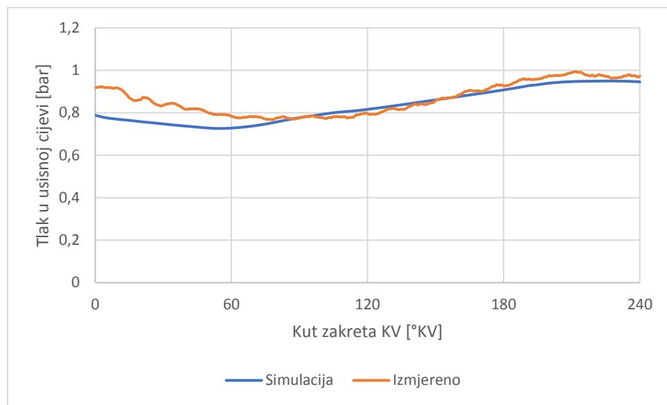
**Slika 8.** Profil izmjerenog i simuliranog tlaka u usisnoj cijevi u taktu usisa za RT 9
