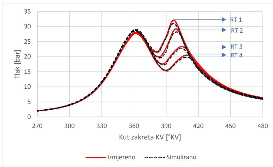
**Slika 10. Profil izmjereno i simuliranog tlaka u cilindru na brzini vrtnje  $n = 1000 \text{ min}^{-1}$**
