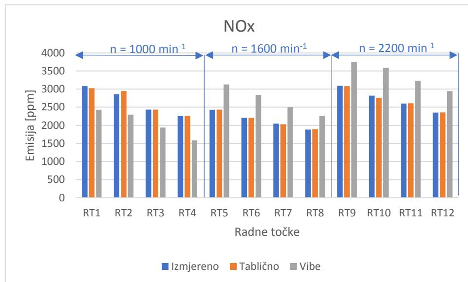
Slika 21. Usporedba emisija NO<sub>x</sub> po radnim točkama
