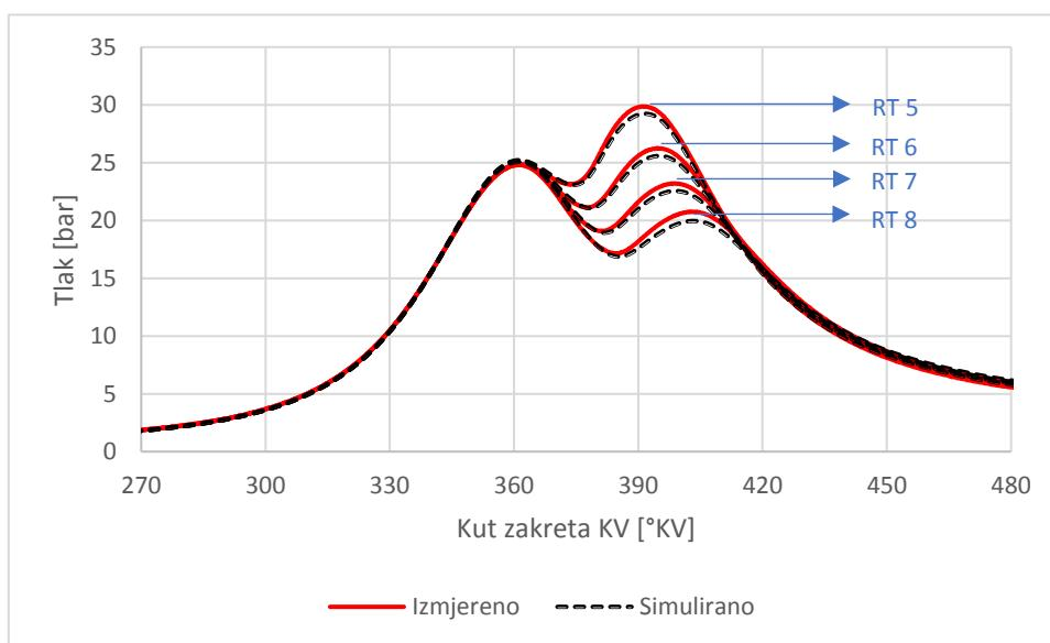
**Slika 11. Profil izmjereno i simuliranog tlaka u cilindru na brzini vrtnje  $n = 1600 \text{ min}^{-1}$**
