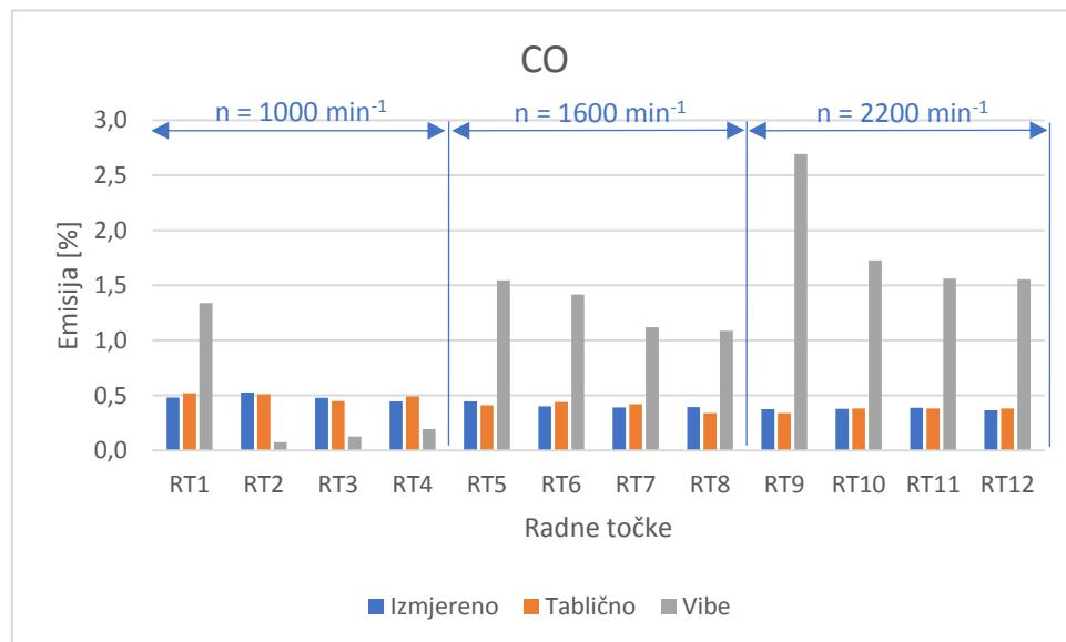
Slika 22. Usporedba emisija CO po radnim točkama
