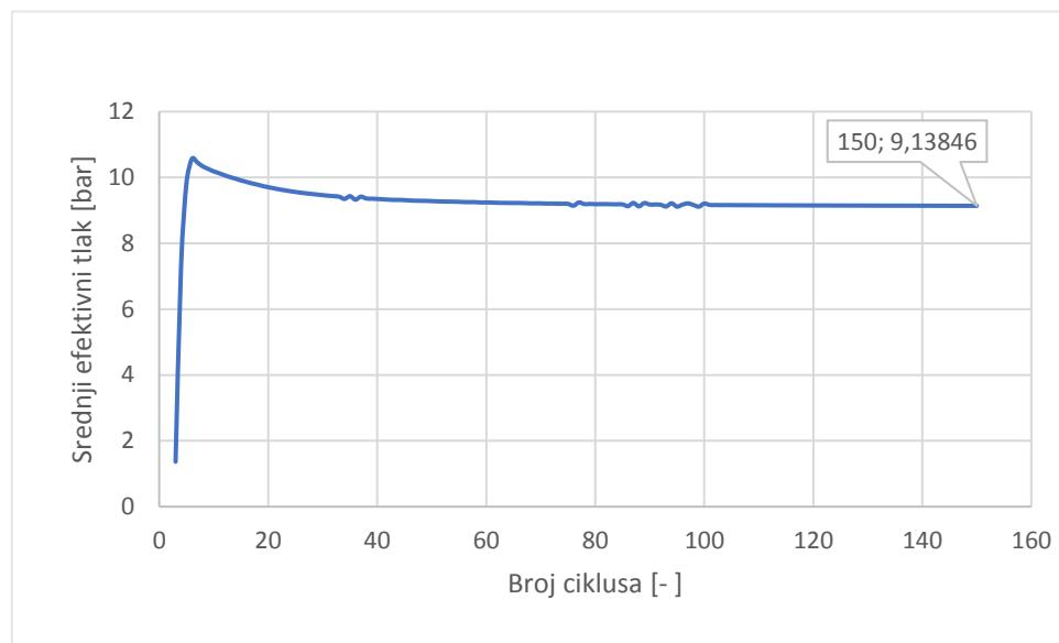
**Slika 9.** Srednji indicirani tlak u RT 9 nakon kalibracije
