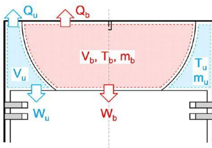
Slika 7. Shematski prikaz 2-Z podjele prostora izgaranja [3]
