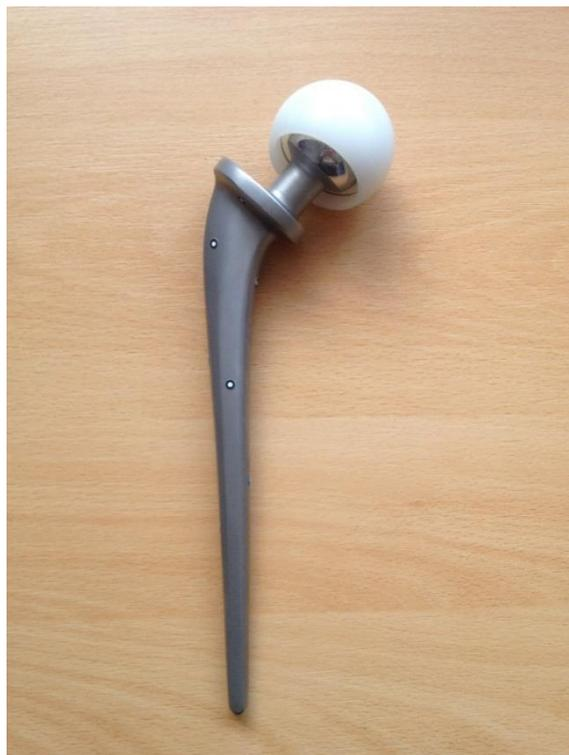
**Slika 11. Uzorak endoproteze s referentnim točkama**
