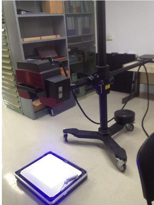
**Slika 10. Kalibracija 3D skenera**
