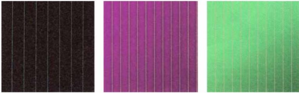
Slika 1. Solarna ćelija od bakar-indij-diselenida (CIS) (lijevo), amorfna silicijeva ćelija (sredina) te solarna ćelija od kadmijeva telurida (CdTe) (desno) [1]
