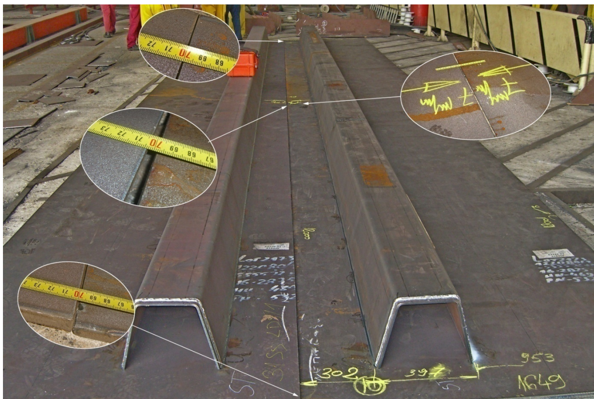
Slika 26: Provođenje dimenzijske kontrole. Brodograđevna industrija Split [25]
