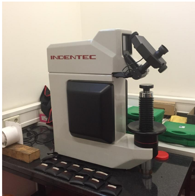
Slika 51. Tvrdomjer korišten za mjerenje tvrdoće
