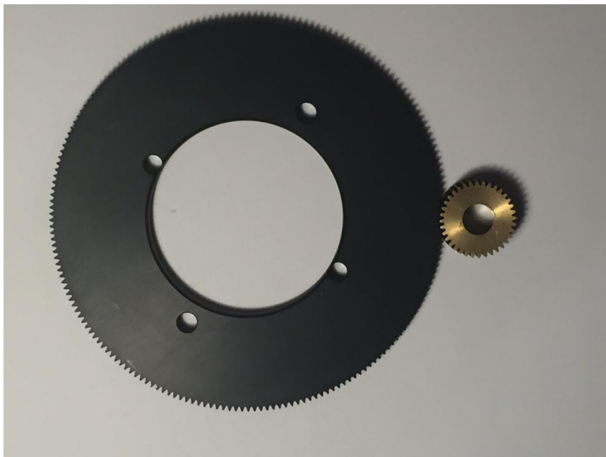
Slika 33. Par zupčanik nakon demontaže
