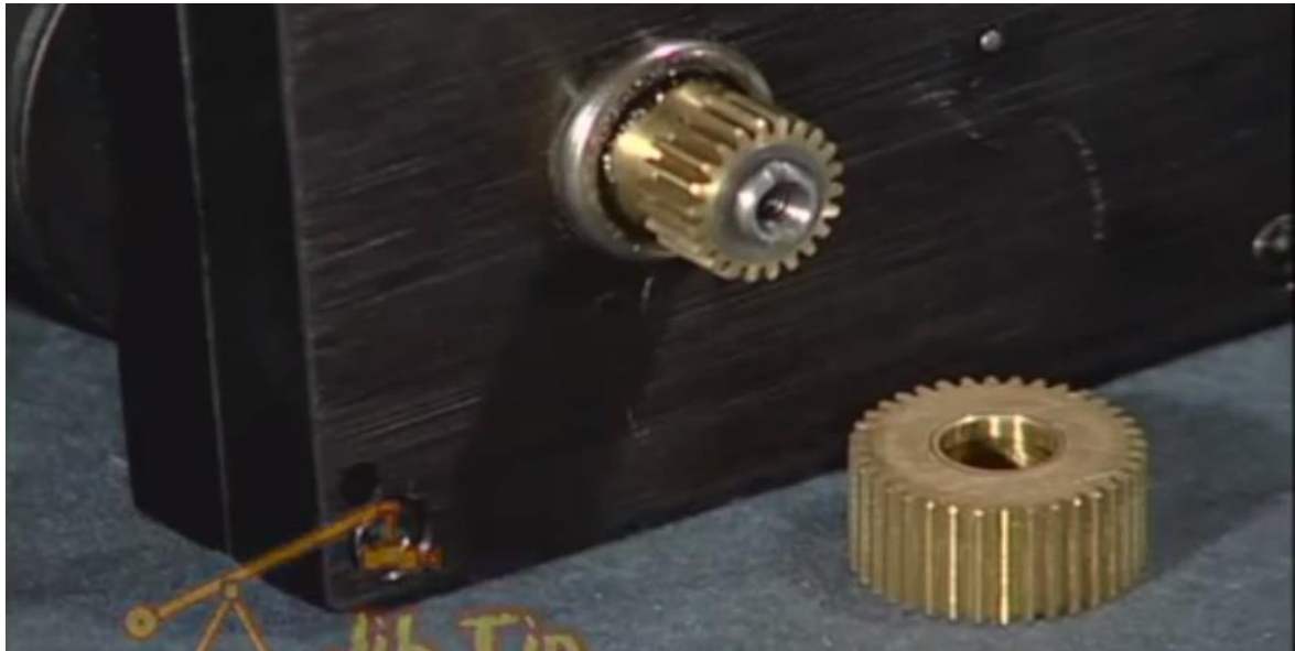
Slika 32. Pogonski zupčanik sa 22 i 36 zubi [25]
