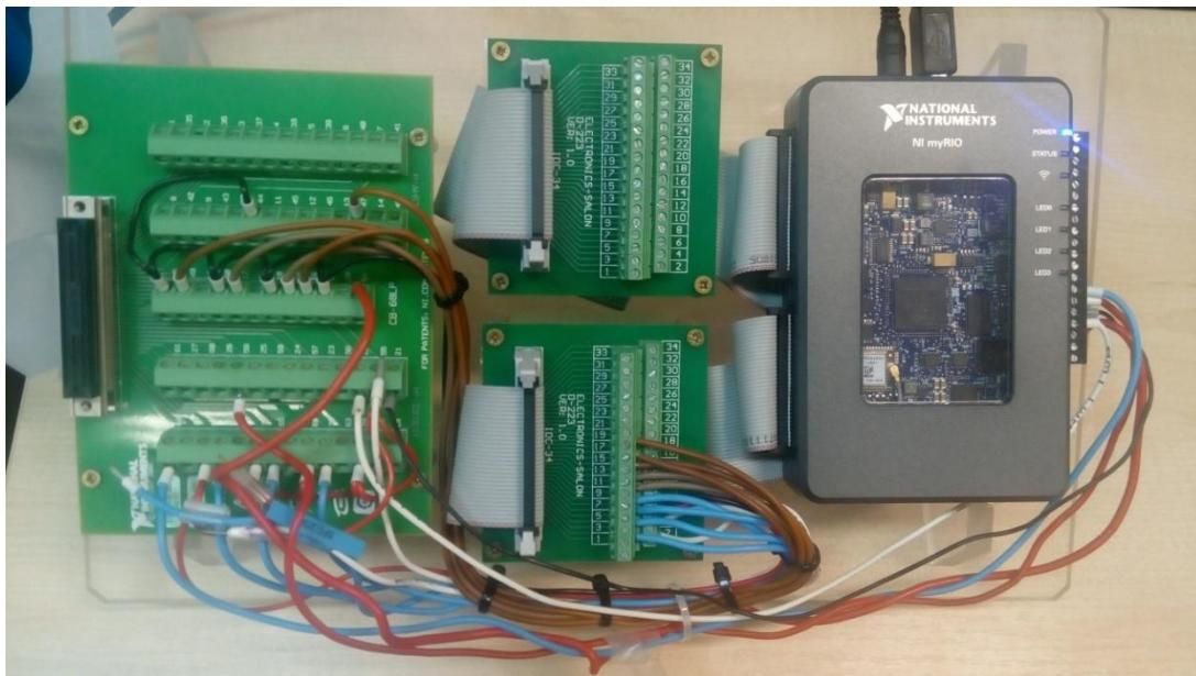
Slika 15. Spoj servo sustava i myRIO uređaja
