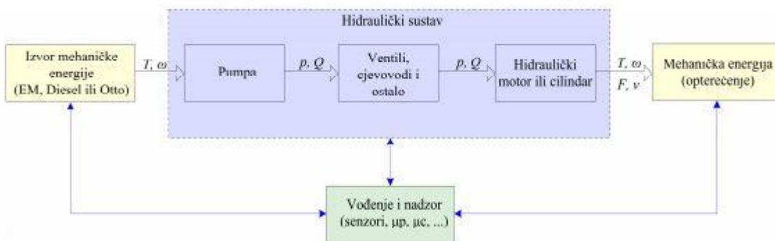
Slika 1. Tok energije kroz hidraulički sustav [1]
