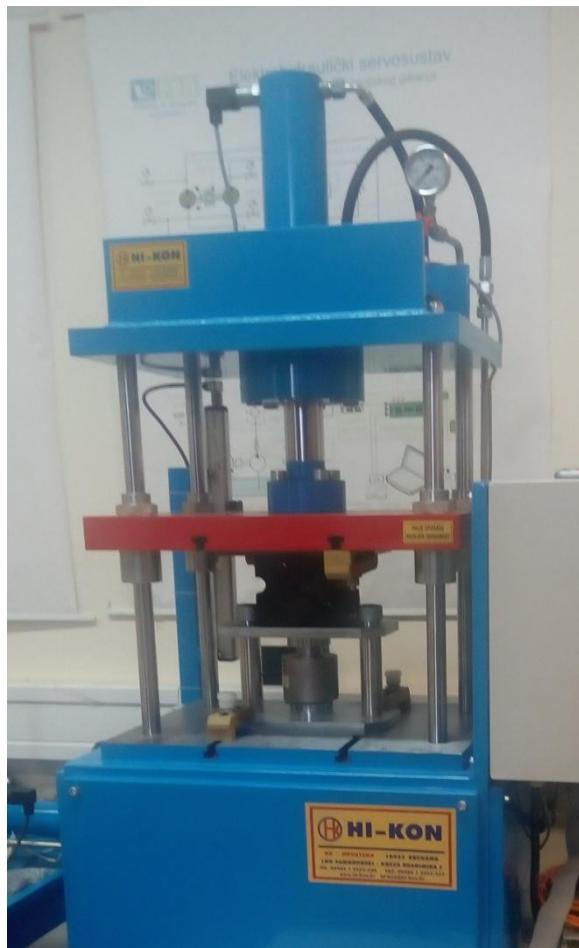
Slika 2. Hidraulička preša
