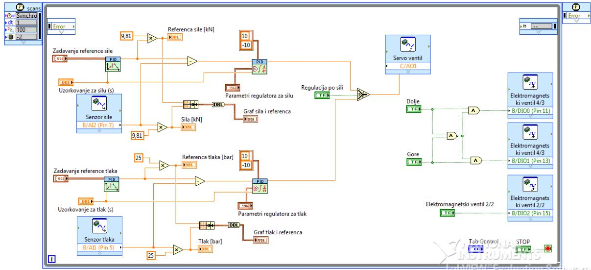
Slika 43. Kontrole elektromagnetskih ventila u blok dijagramu
