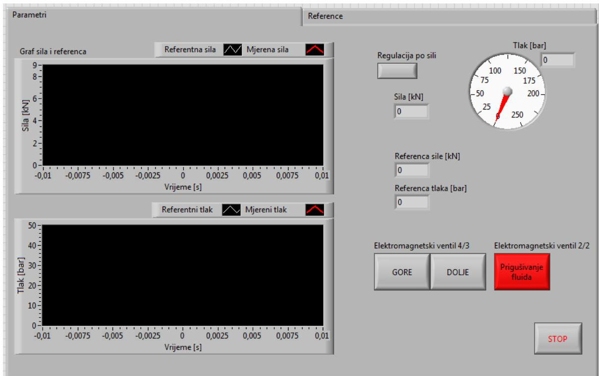
Slika 44. Kontrole elektromagnetskih ventila na front panelu
