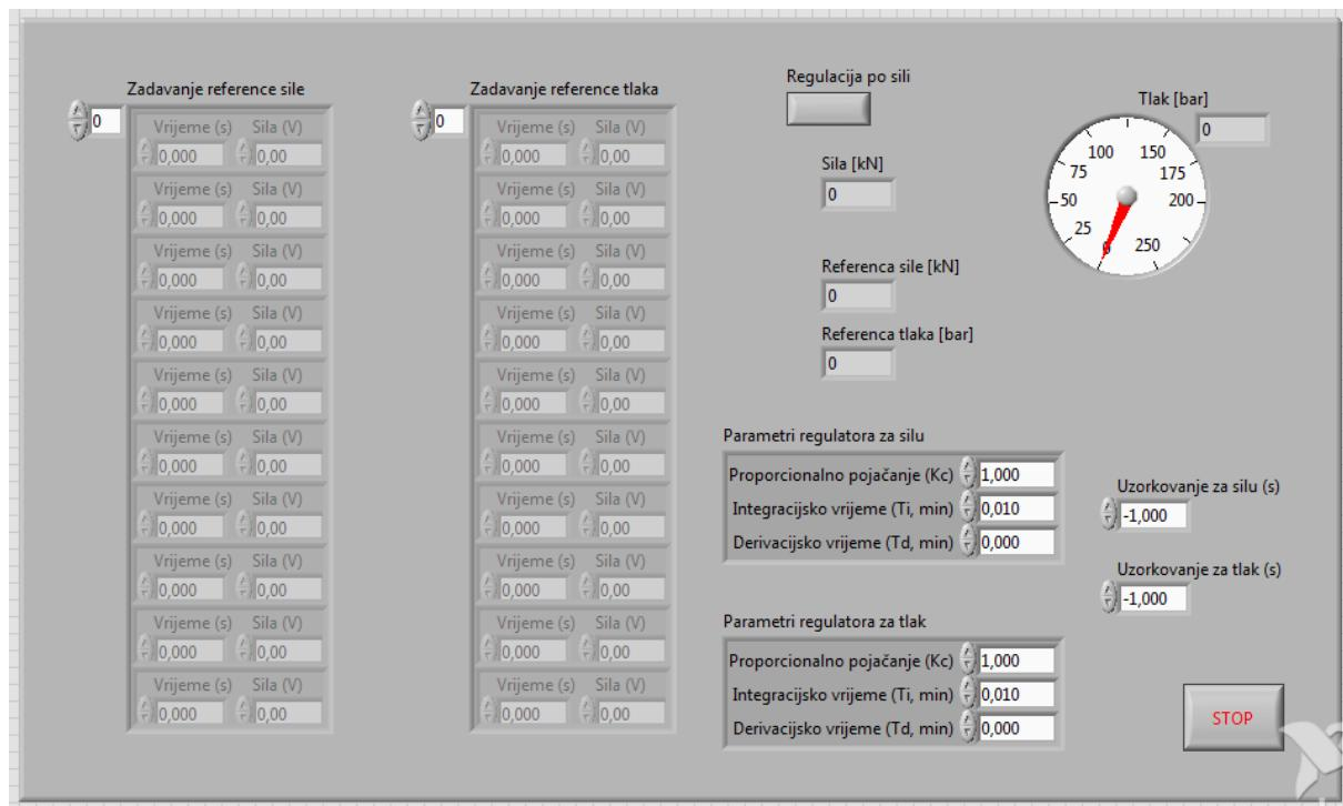
Slika 38. Regulacija po tlaku na front panelu
