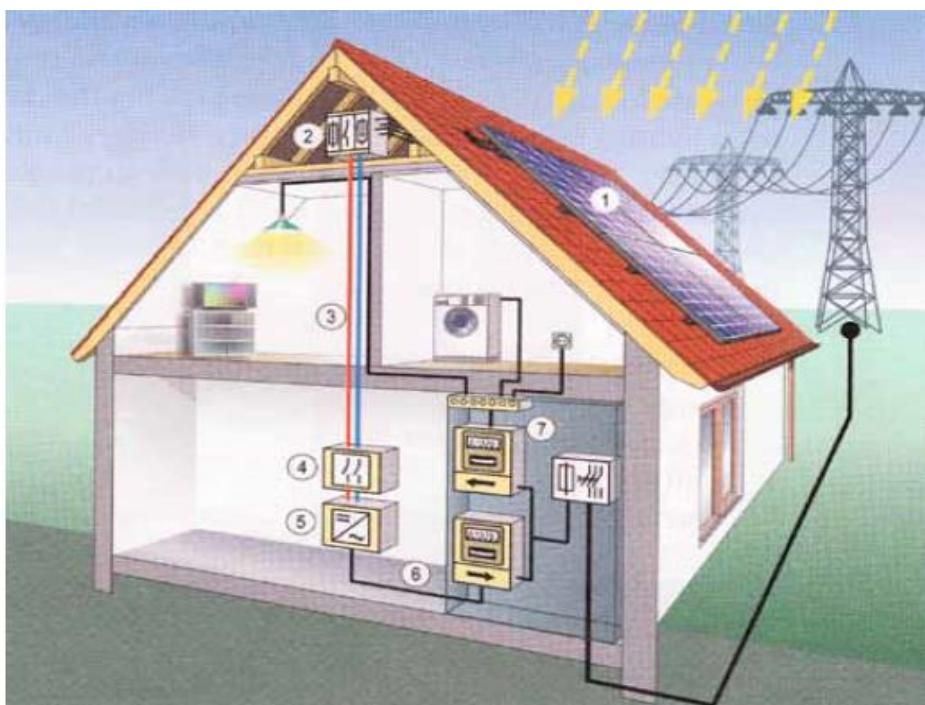
**Slika 4.** Kućna instalacija PV sustava na mrežu [7]
