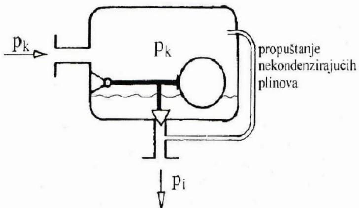
Slika 10. Ventil s plovkom na visokotlačnoj strani [1]
