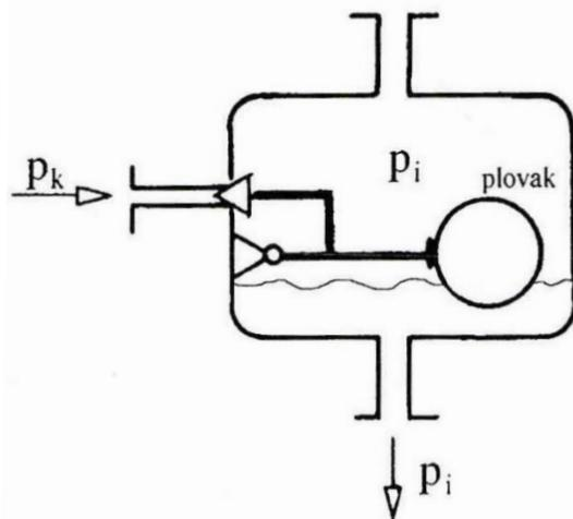
Slika 11. Ventil s plovkom na niskotlačnoj strani [1]
