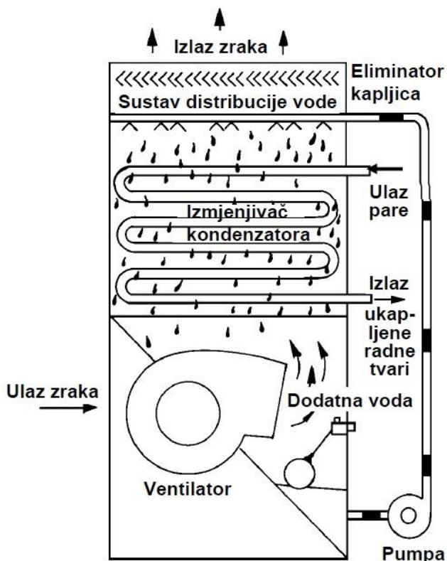
Slika 5. Evaporativni kondenzator [2]
