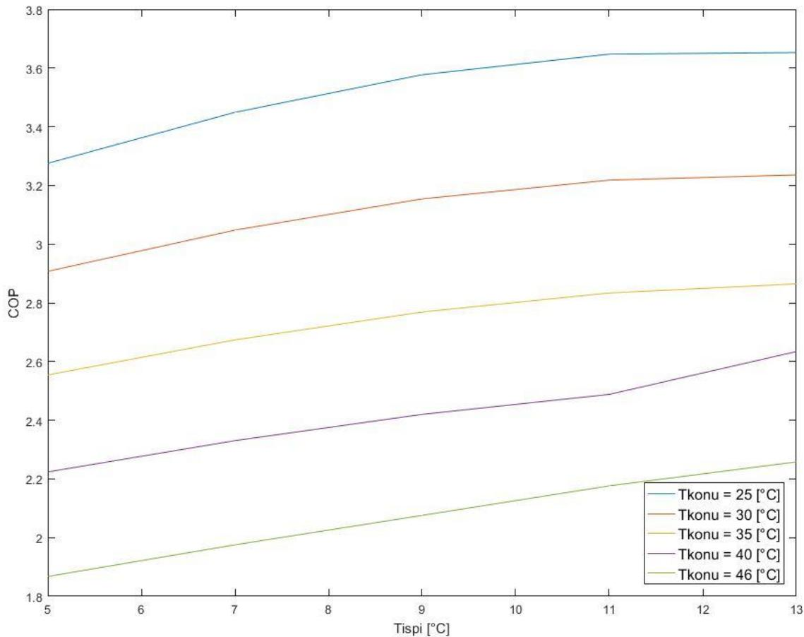
Slika 17. Ovisnost COP-a o izlaznoj temperaturi vode isparivača
