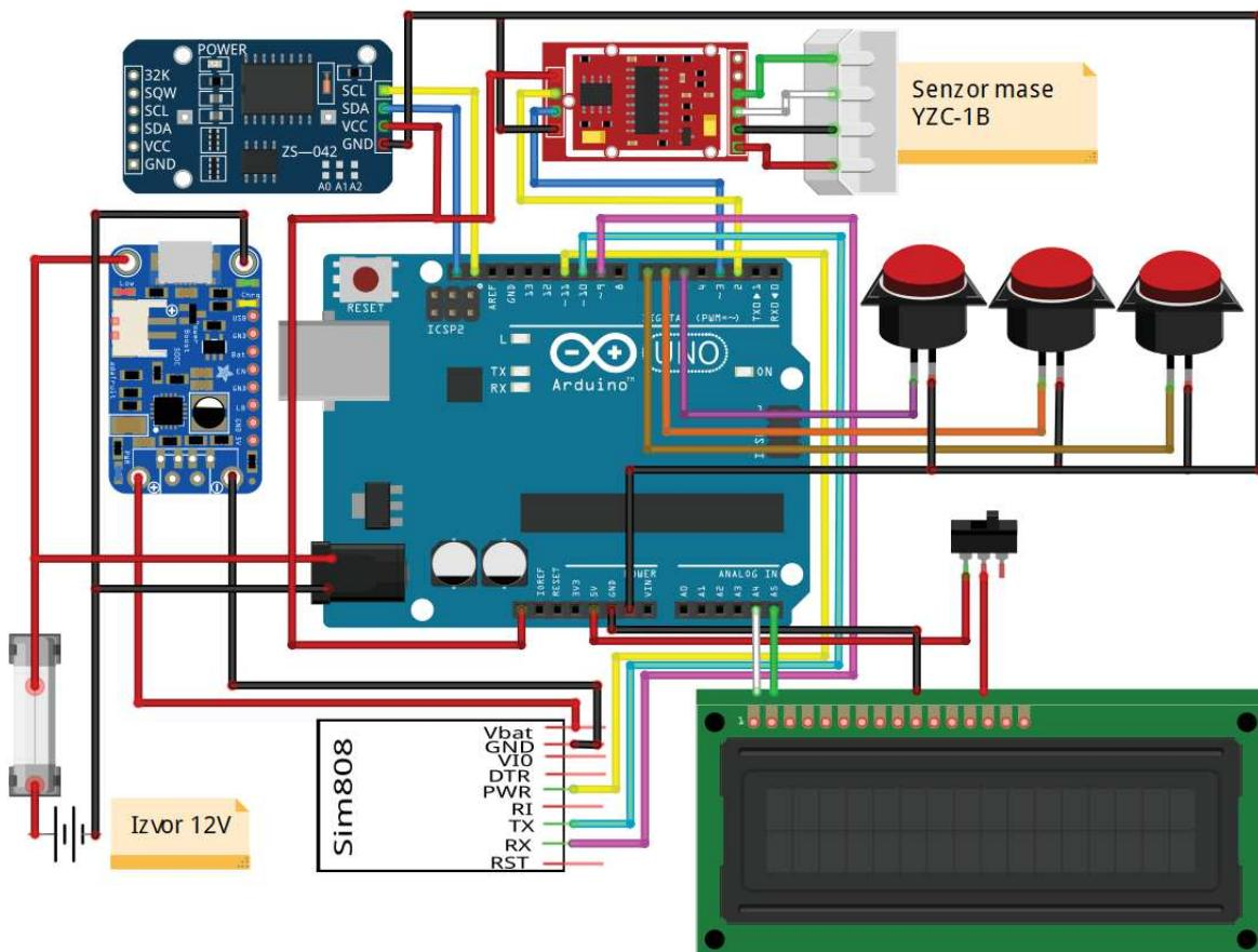
Slika 25. Shematski spoj komponenta elektroničke vage
