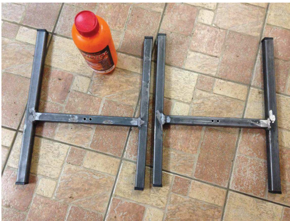
Slika 21. Odmaščivanje i priprema konstrukcije za nanošenje temeljnog premaza
