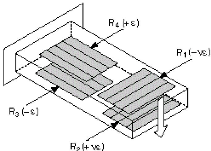
Slika 9. Konfiguracija punog mosta sa četiri tenzometarske trake [10]
