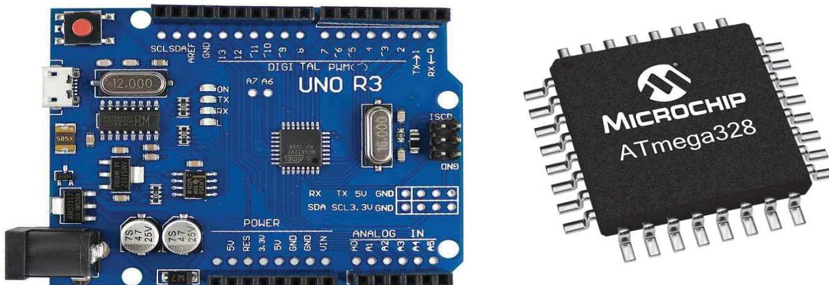
Slika 3. Arduino Uno i ATmega328AU [1][2]
