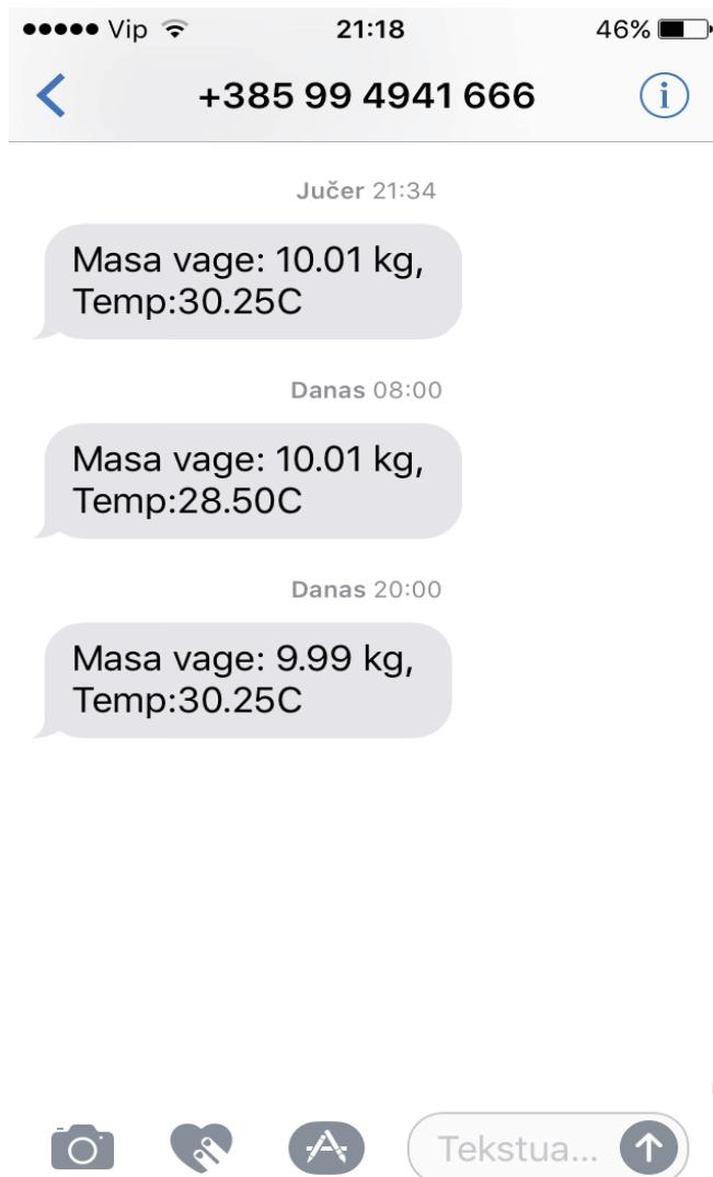
Slika 42. Eksperimentalno testiranje sustava električke vase
