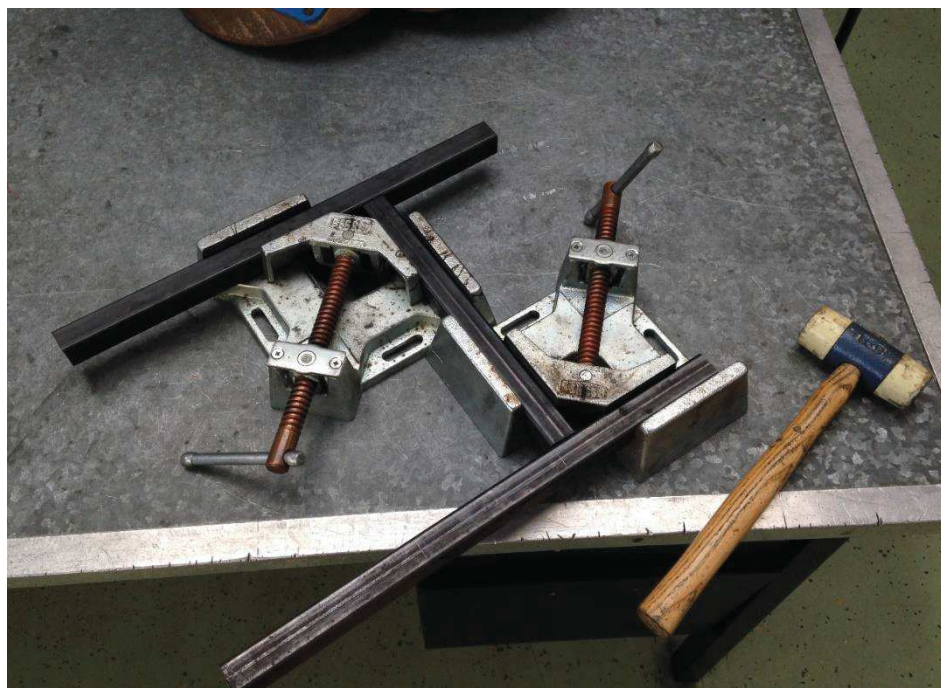
Slika 19. Postavljanje profila u kutni škrip i stezanje
