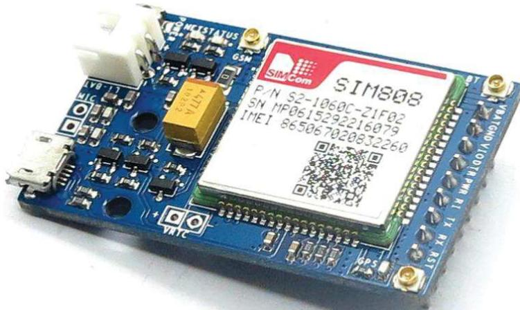
Slika 13. SIM808 GSM, GPS, Bluethooth modul [14]
