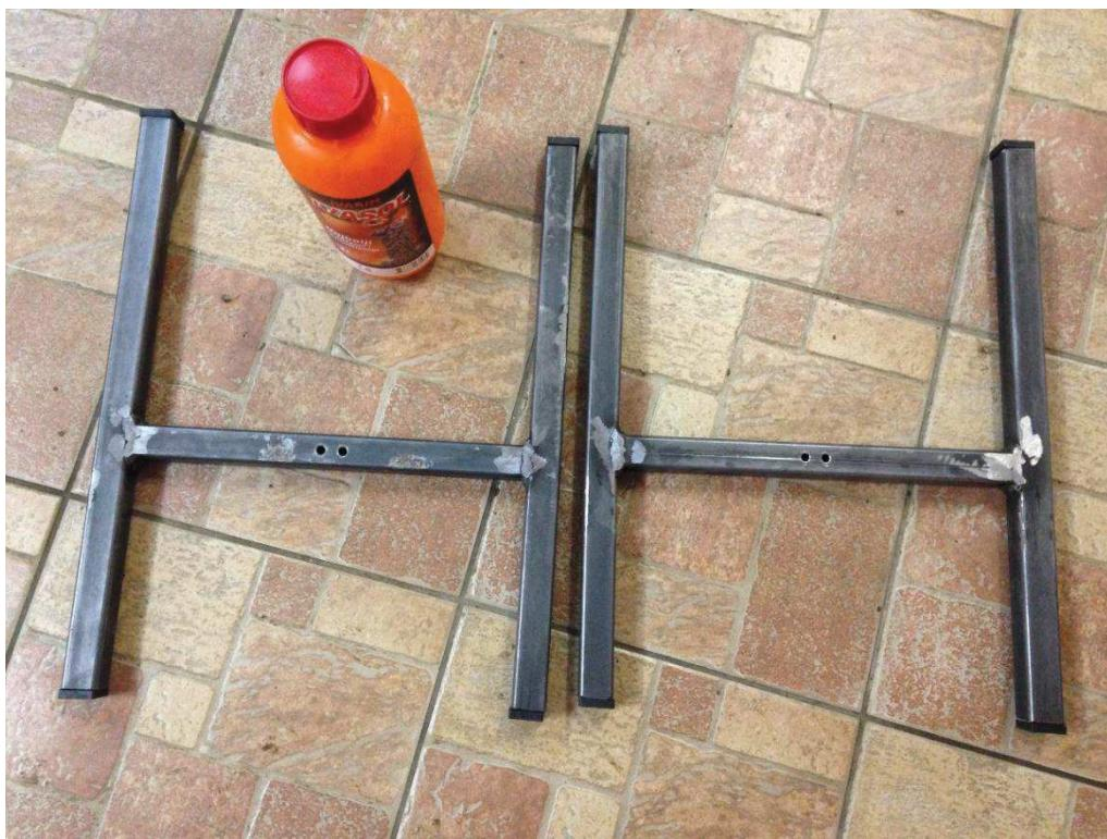
Slika 21. Odmašćivanje i priprema konstrukcije za nanošenje temeljnog premaza
