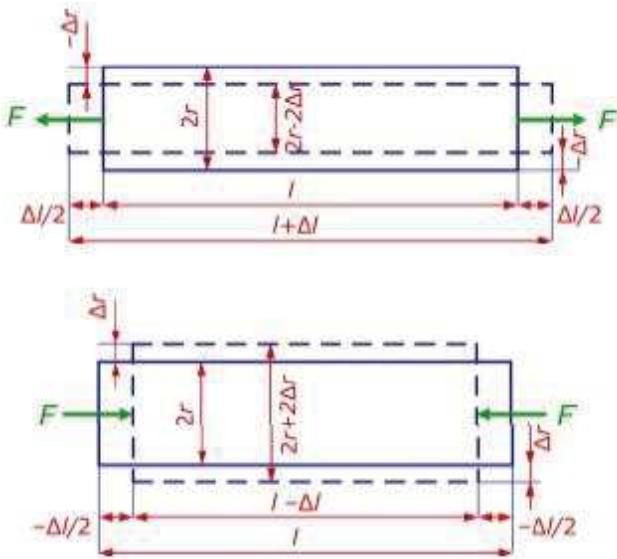
Slika 6. Uzdužna i poprečna deformacija žice [9]
