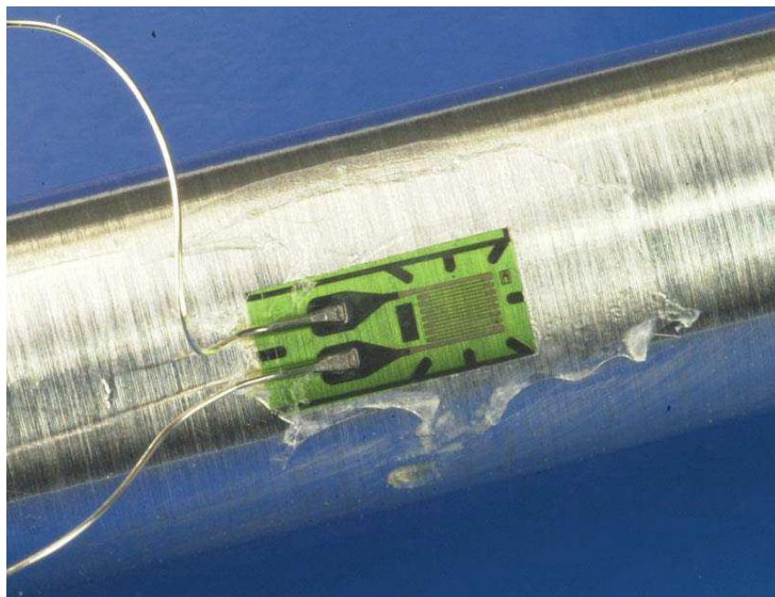
Slika 5. Montiranje tenzometarske trake lijepljenjem na konstrukciju [7]
