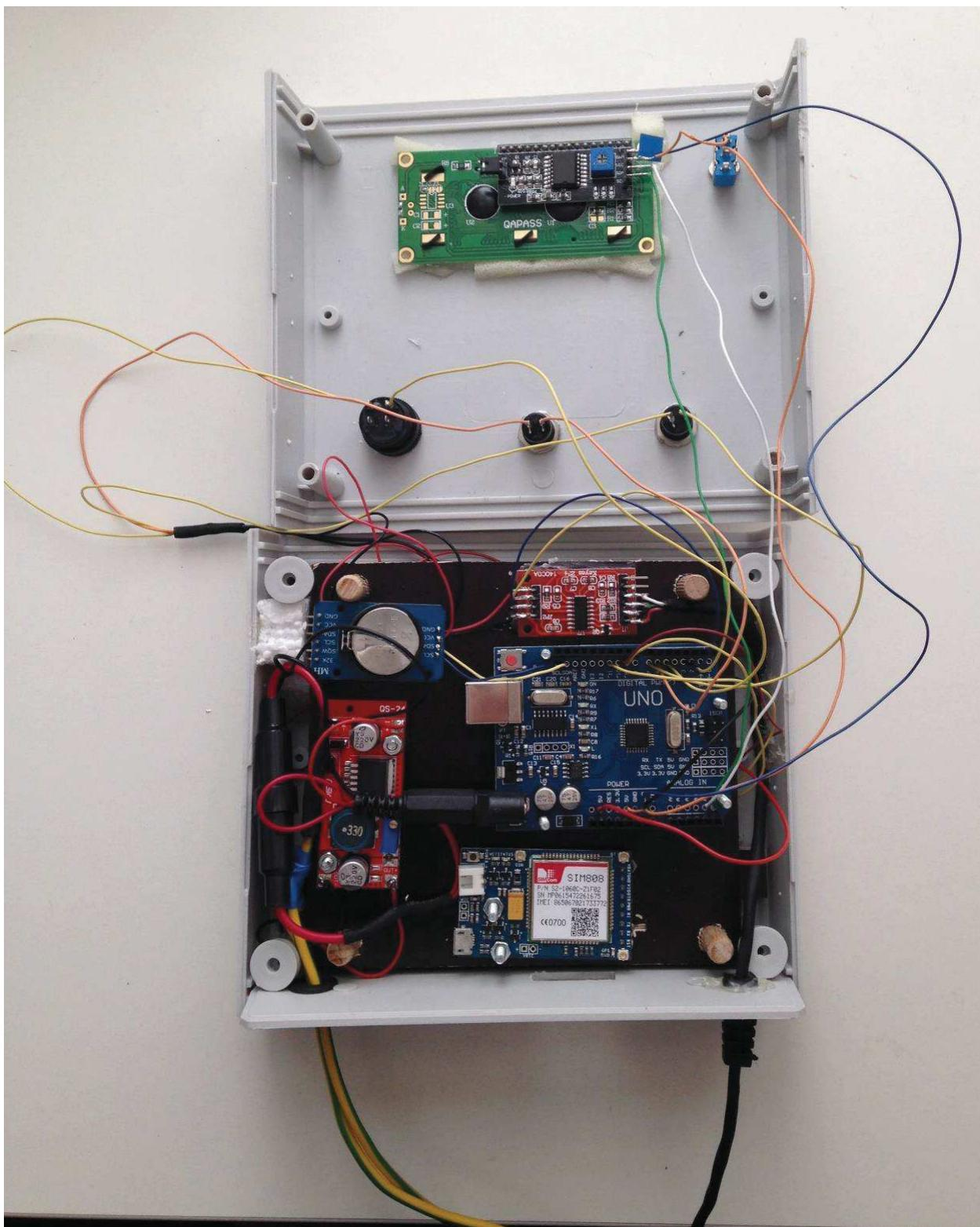
Slika 27. Povezane i pozicionirane komponente elektroničke vase
