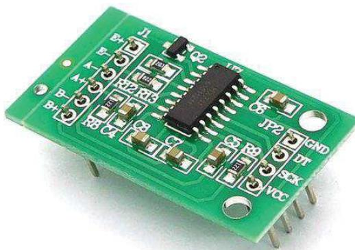
Slika 10. Analogno digitalni pretvornik i pojačalo HX711 [11]
