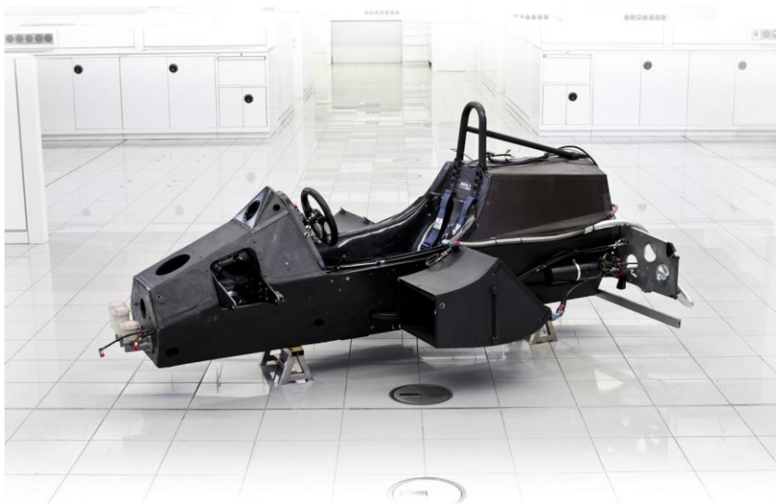
Slika 1. McLaren MP4/1 okvir od kompozita s ugljičnim vlaknima [2]
