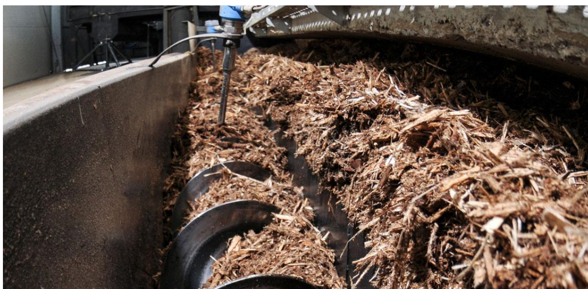
Slika 6. Prijenos biomase pužnim vijcima [7]
