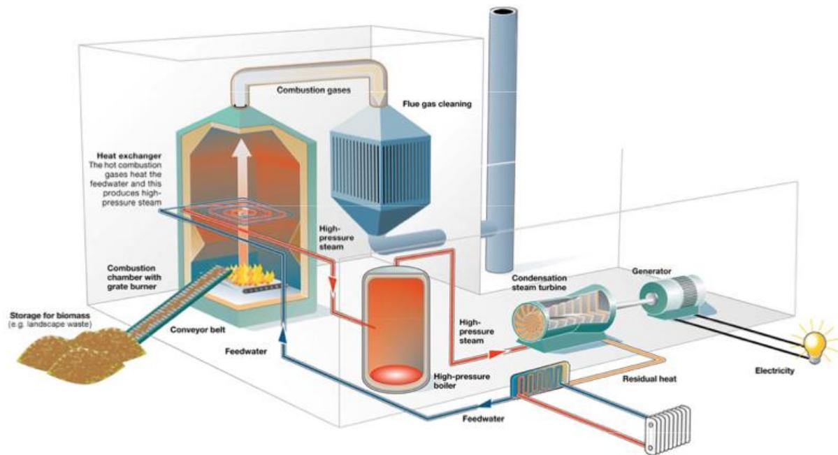
Slika 7. Presjek postrojenja na drvnu biomasu [8]
