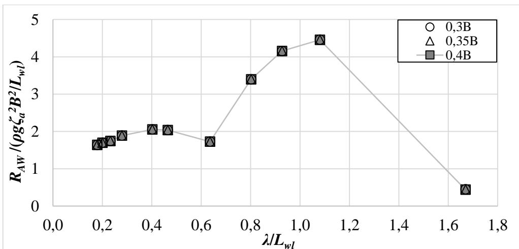
Slika 51. Utjecaj radijusa tromosti mase oko osi x na dodatni otpor na valovima kod  $\beta=150^\circ$  za KVLCC2 pri  $Fr = 0,142$
