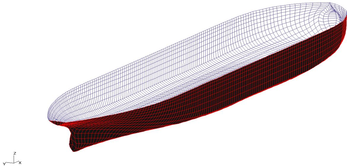
**Slika 8. Panelni model tankera KVLCC2 za stanje punog opterećenja**
