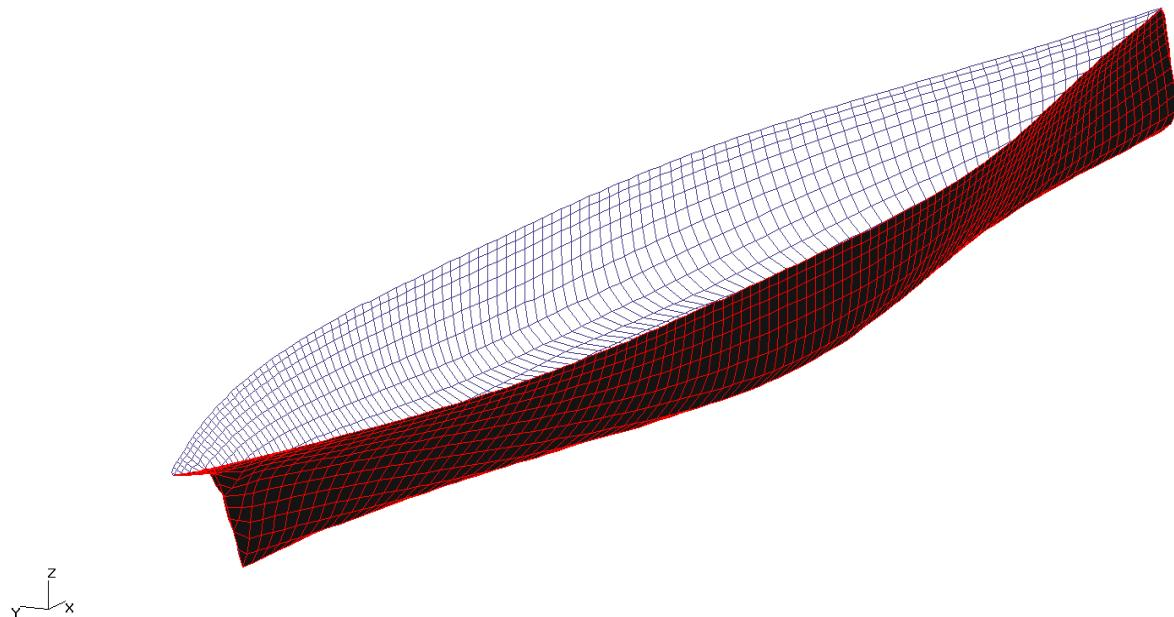
**Slika 7. Panelni model kontejnerskog broda S175 za stanje punog opterećenja**
