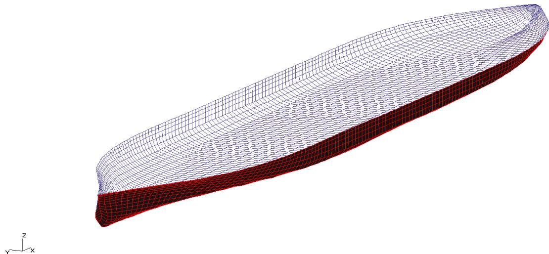
**Slika 10. Panelni model tankera KVLCC2 za balastno stanje**
