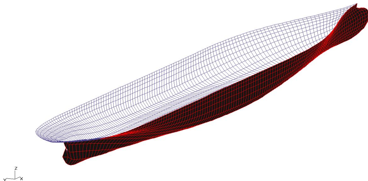
**Slika 6. Panelni model kontejnerskog broda KCS za stanje punog opterećenja**
