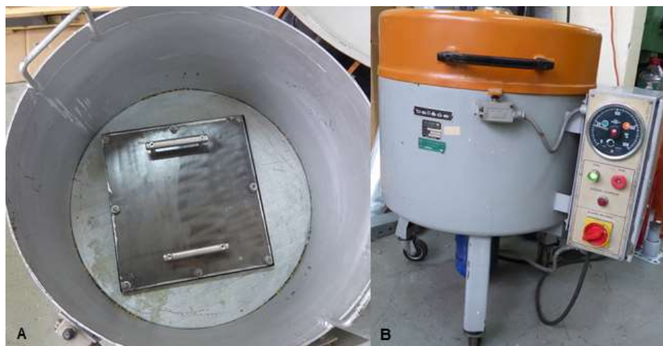
Slika 6.11. Peć: a) kalup u unutrašnjosti peći, b) zatvorena peć
