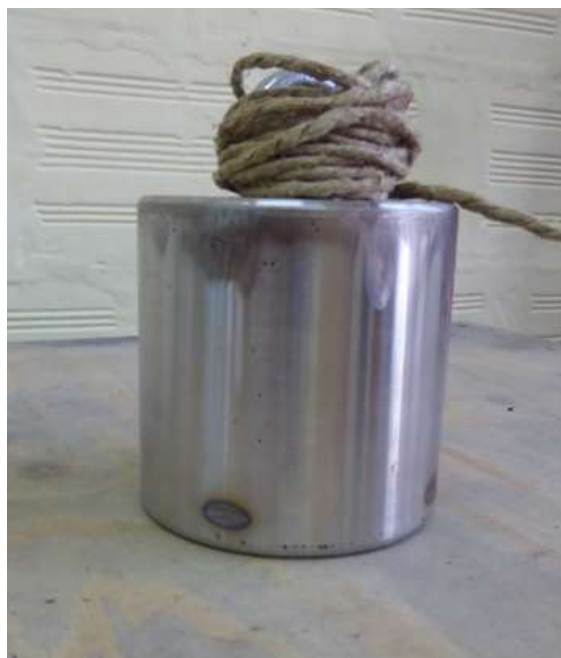
Slika 6.14. Udarni uteg mase 2,64 kg
