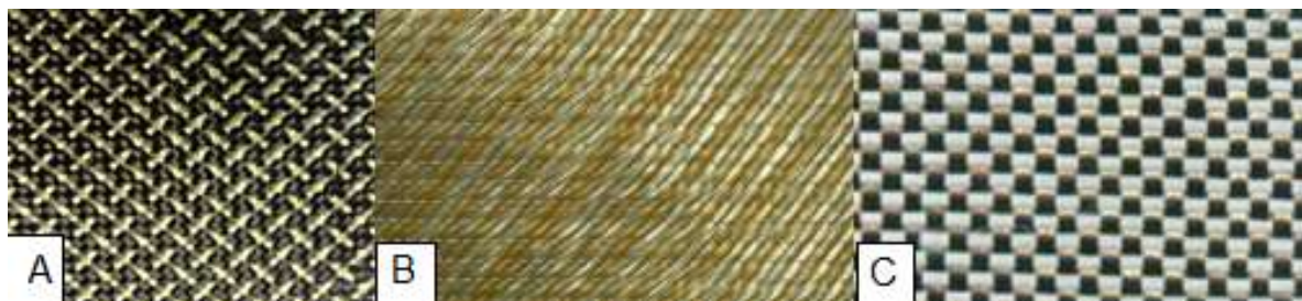
Slika 5.5. Različita hibridna tkanja: a) ugljik/aramid, b) aramid/staklo, c) ugljik/staklo [5,29]
