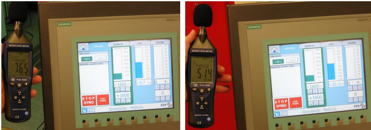
Slika 4.27 Razina buke u kontrolnoj sobi pri radu MSUI na 1600 \text{ min}^{-1} s otvorenim vratima (lijevo) i sa zatvorenim (desno)
