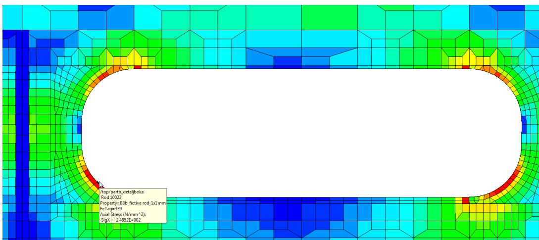
Slika 29. Očitavanje aksijalnog naprezanja sa štapnog elementa ( $r = 400$  mm)
