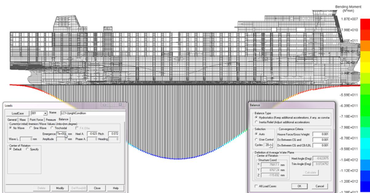
**Slika 26. Distribucija vertikalnog momenta savijanja za LC1**
