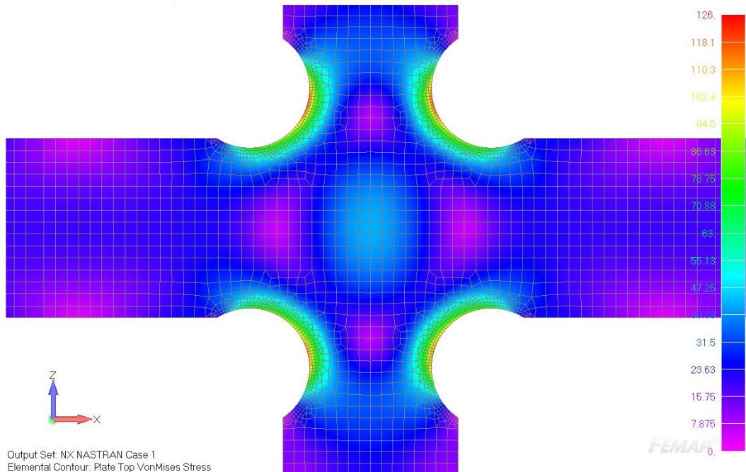
**Slika 22. Prikaz ekvivalentnih naprezanja na geometriji kuta otvora „mišje uši“**
