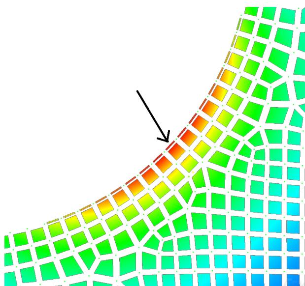
Slika 20. Prikaz očitavanja aksijalnih naprezanja sa štapnih elemenata
