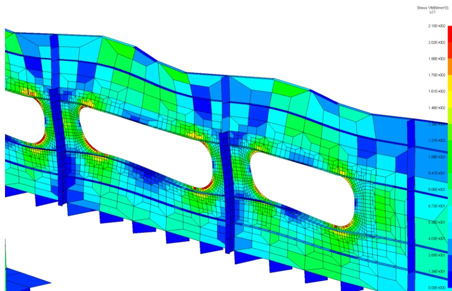
**Slika 27. Deformirani model detalja otvora vanjske oplate nadgrađa**
