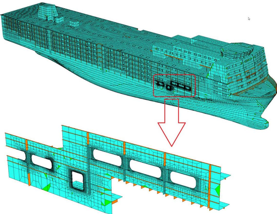
**Slika 24. Prikaz detalja vanjske oplate nadgrađa sa otvorima**
