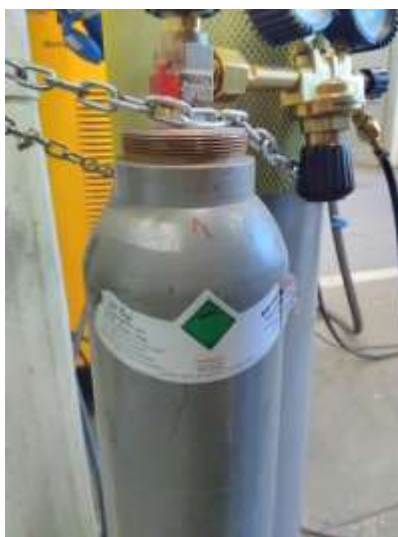
Slika 20. Mješavina zaštitnog plina Ar 75,5 % i \text{CO}_2 2,5 %
