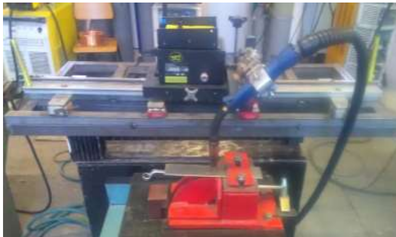
Slika 19. „Bug“ sustav za automatizaciju MIG/MAG zavarivanja
