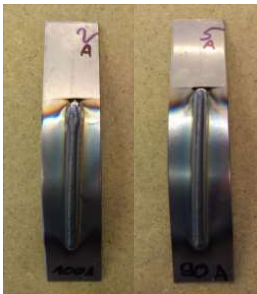
Slika 24. Uzorci slučaja A bez vidljivih pukotina
