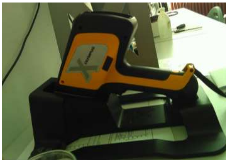
Slika 27. XRF uređaj za ispitivanje kemijskog sastava materijala
