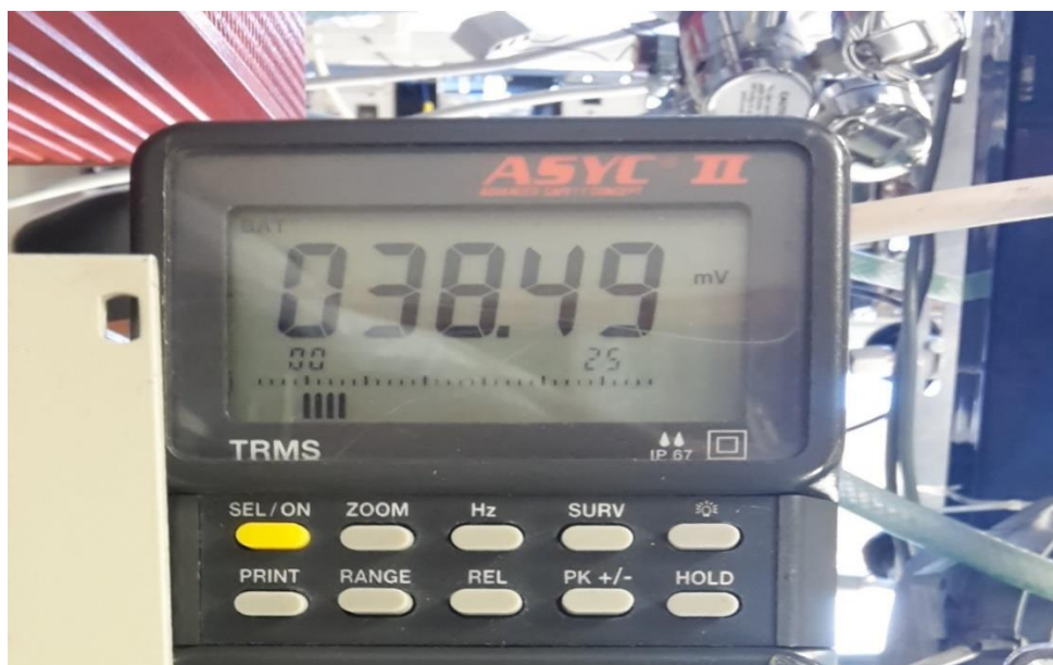
Slika 37. Iznos napona potrebnog za rast grafena
