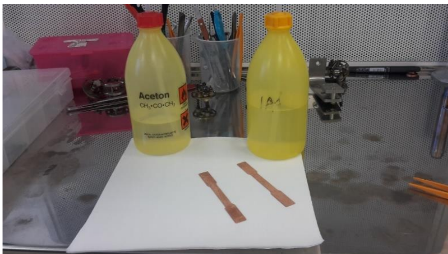
Slika 25. Uzorci nakon čišćenja acetonom i izopropilnim alkoholom
