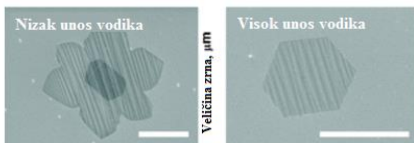
Slika 39. Utjecaj vodika na oblik, veličinu i kvalitetu nastalog grafena [39]
