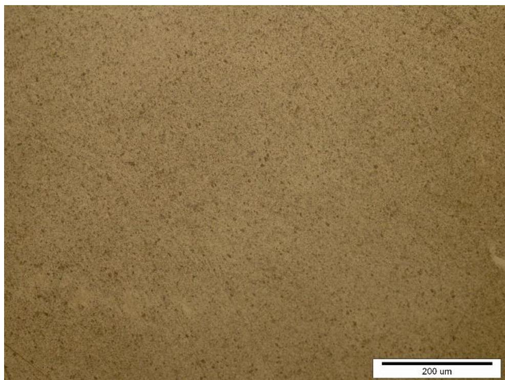
Slika 36. Mikrostruktura uzorka 30/ nedozrijevano, gašeno u vodi
