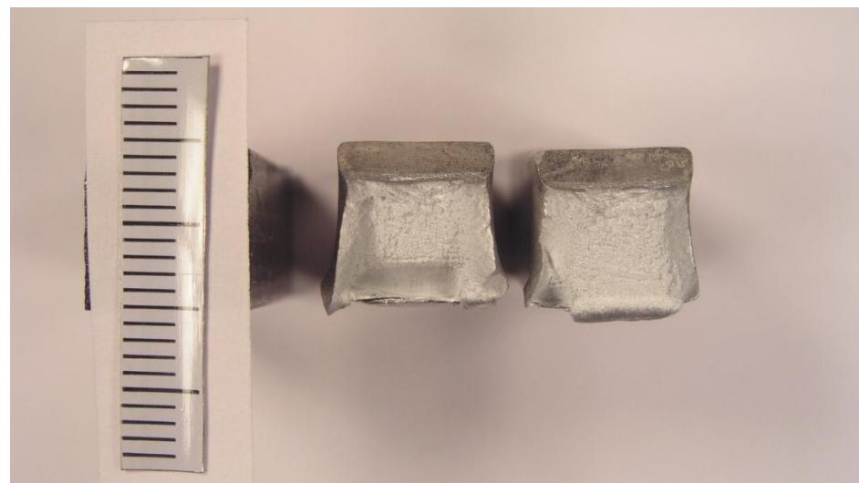
Slika 78. Prijelomna površina epruvete 30 / rastvorno žareno i gašeno u vodi
