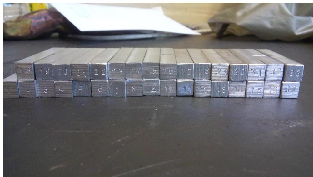
Slika 26. Epruvete nakon označivanja
