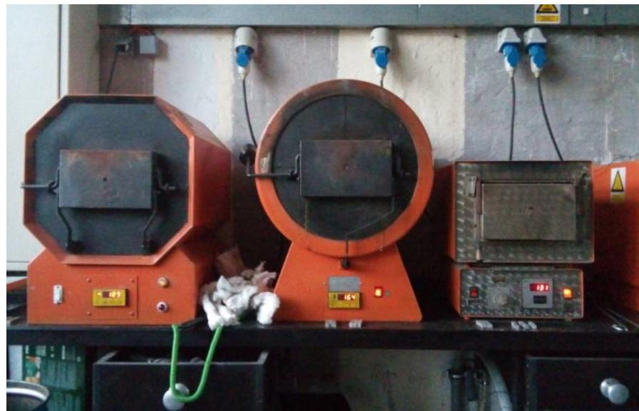
Slika 29. Komorne elektro-peći
