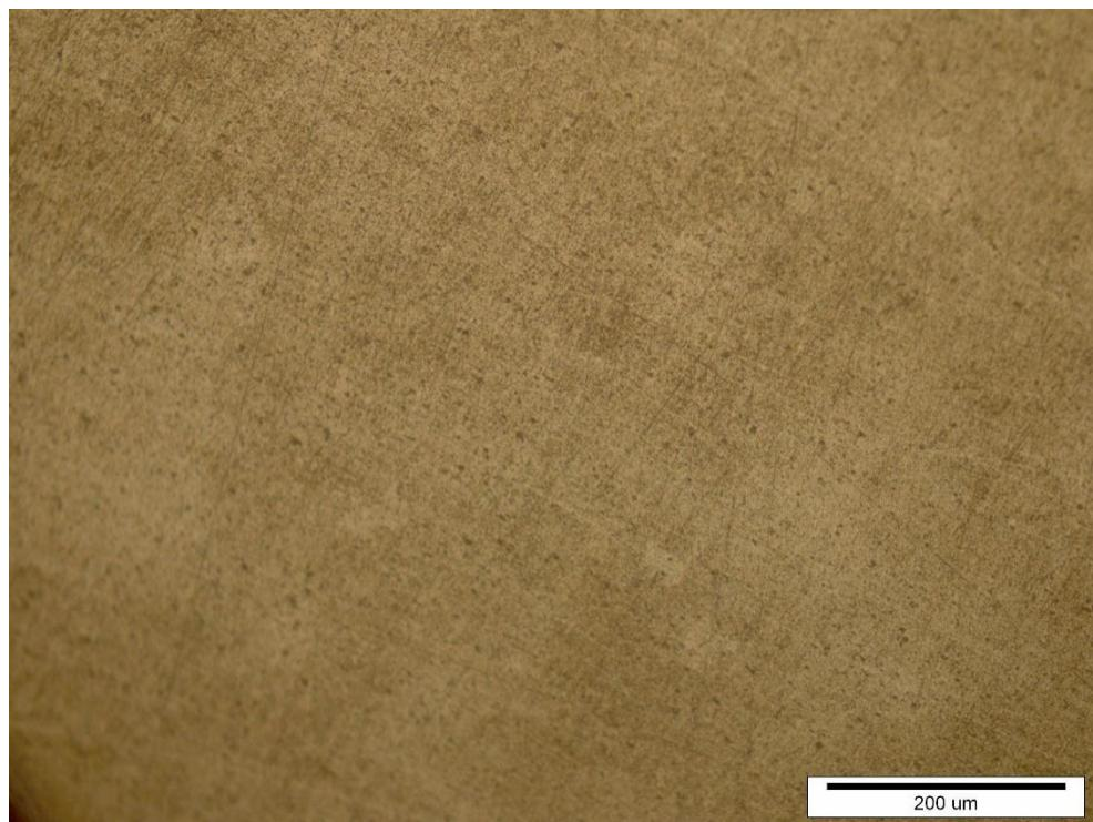
Slika 54. Mikrostruktura uzorka 25/ dozrijevano 10 h pri 190 °C
