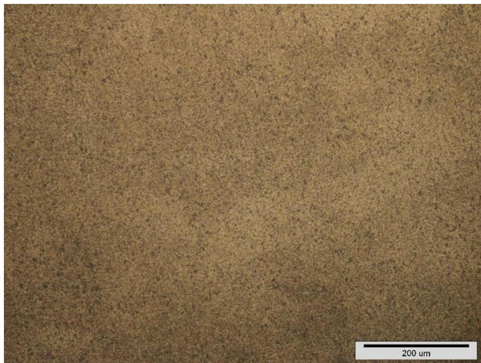
Slika 52. Mikrostruktura uzorka 22/ dozrijevano 4 h pri 190 °C
