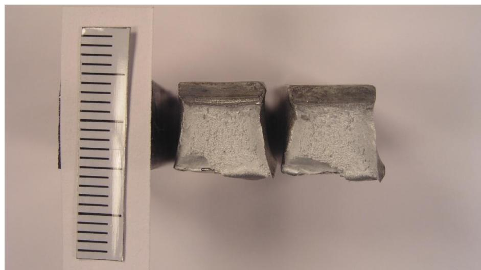
Slika 79. Prijelomna površina epruvete 33 / rastvorno žareno i hlađeno na zraku
