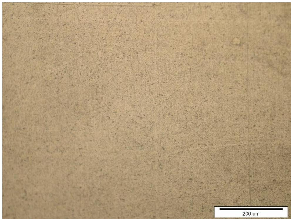
Slika 38. Mikrostruktura uzorka 1/ dozrijevano 1 h pri 130 °C
