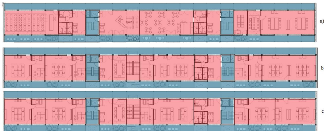
Slika 30 Prikaz grijanih (crveno) i negrijanih (plavo) zona; a) prizemlje, b) prvi kat, c) drugi kat
