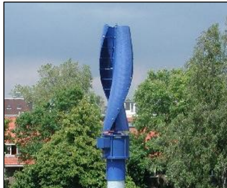
Slika 3.11. Spiralna Savoniusova vjetroturбина
