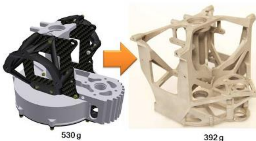
Slika 11. Primjer topološke optimizacije smanjenja mase u iznosu od 25 %
