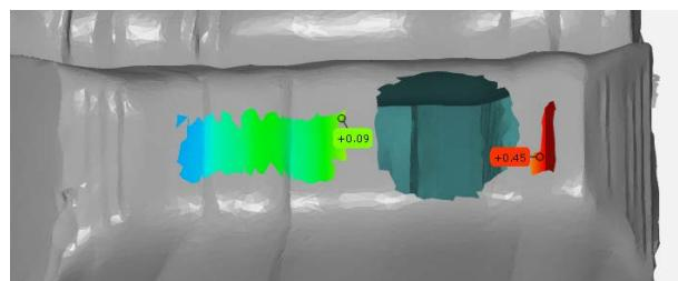
**Slika 79 Odstupanja točnosti vrtnje u radijalnom smjeru na zubu 20 zupčanika Z1.3**
