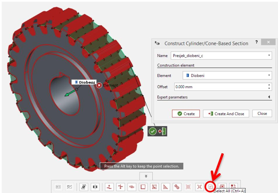
**Slika 42 Postupak kreiranja presjeka cilindra i cijelog zupčanika**
