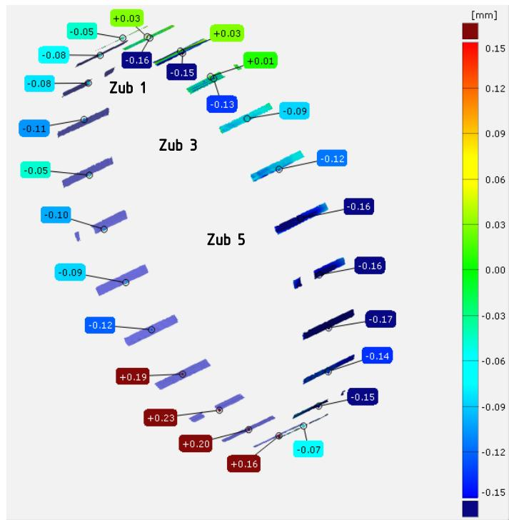
Slika 75 Odstupanja vrtnje u radikalnom smjeru – zupčanik Z1.1
