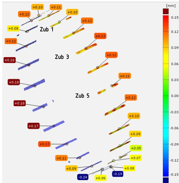
Slika 76 Odstupanja vrtnje u radikalnom smjeru – zupčanik Z1.2
