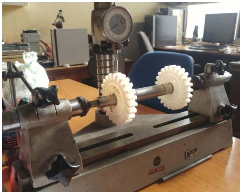
Slika 13 Mjerenje odstupanja vrtnje u radijalnom smjeru
