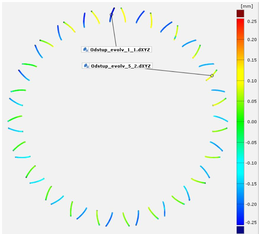
Slika 60 Odstupanja od evolvente – zupčanik Z1.2
