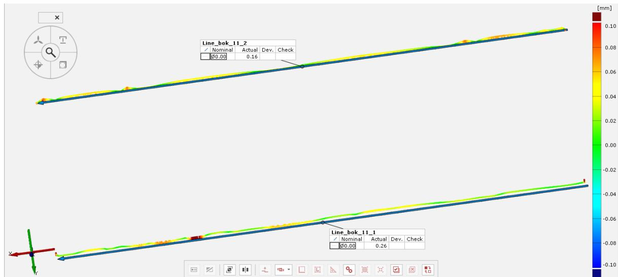
Slika 46 Odstupanje uzdužnih linija boka zuba 11 zupčanika Z1.2
