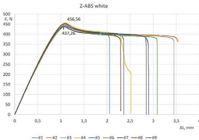
**Slika 5 Dijagram sila - produljenje za materijal Z-ABS white [13]**
