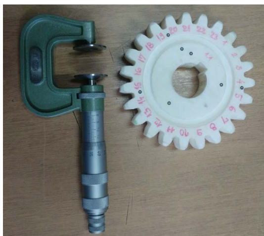
Slika 16 Mikrometar za mjerenje mjere preko zubi
