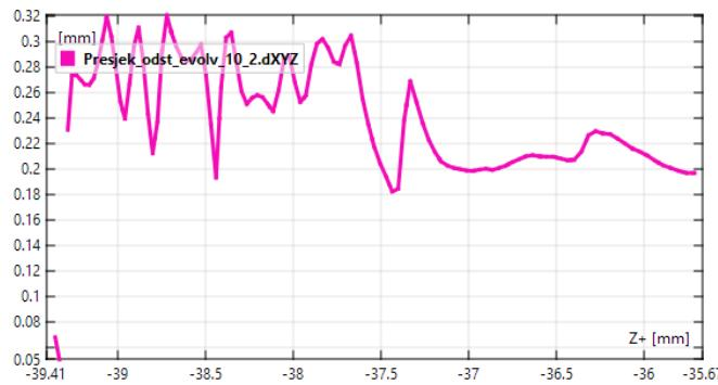
Slika 62 Dijagram odstupanja od evolvente za bok zuba 10\_2 zupčanika Z1.1
