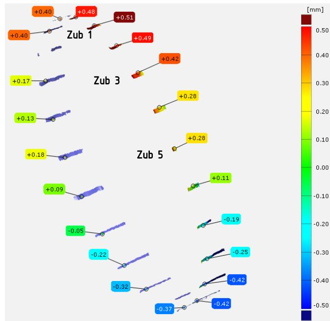
Slika 77 Odstupanja vrtnje u radijalnom smjeru – zupčanik Z1.3
