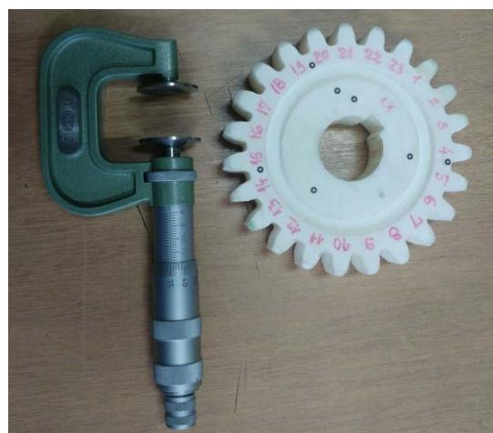
**Slika 16 Mikrometar za mjerjenje mjere preko zubi**
