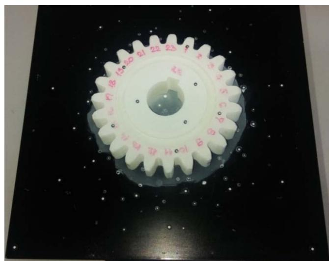
Slika 23 Zupčanik 1.2 sa slojem titanovog oksida
