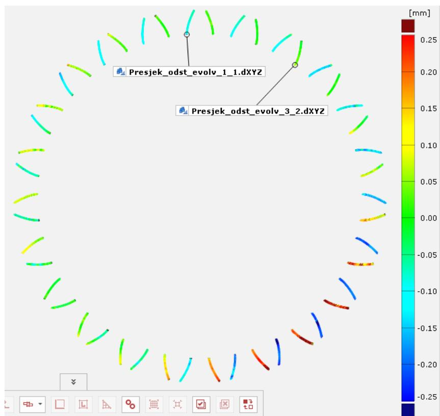
Slika 59 Odstupanja od evolvente – zupčanik Z1.1
