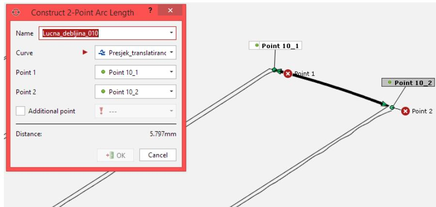
Slika 54 Konstruiranje stvarne lučne debljine zuba 10 zupčanika Z1.1
