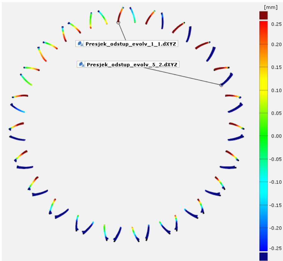
Slika 61 Odstupanja od evolvente – zupčanik Z1.3
