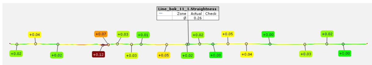
Slika 47 Prikaz odstupanja jedne uzdužne linije boka 11 zupčanika Z1.2
