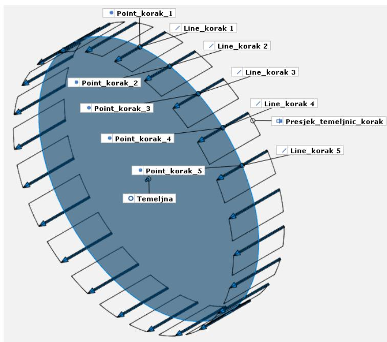
Slika 56 Nominalni presjek temeljnog cilindra i zupčanika
