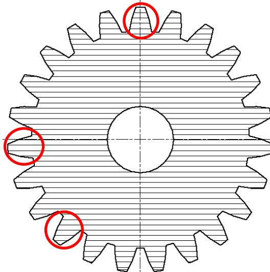
Slika 18 Prikaz položaja slojeva izrade kod zupčanika Z1.1
