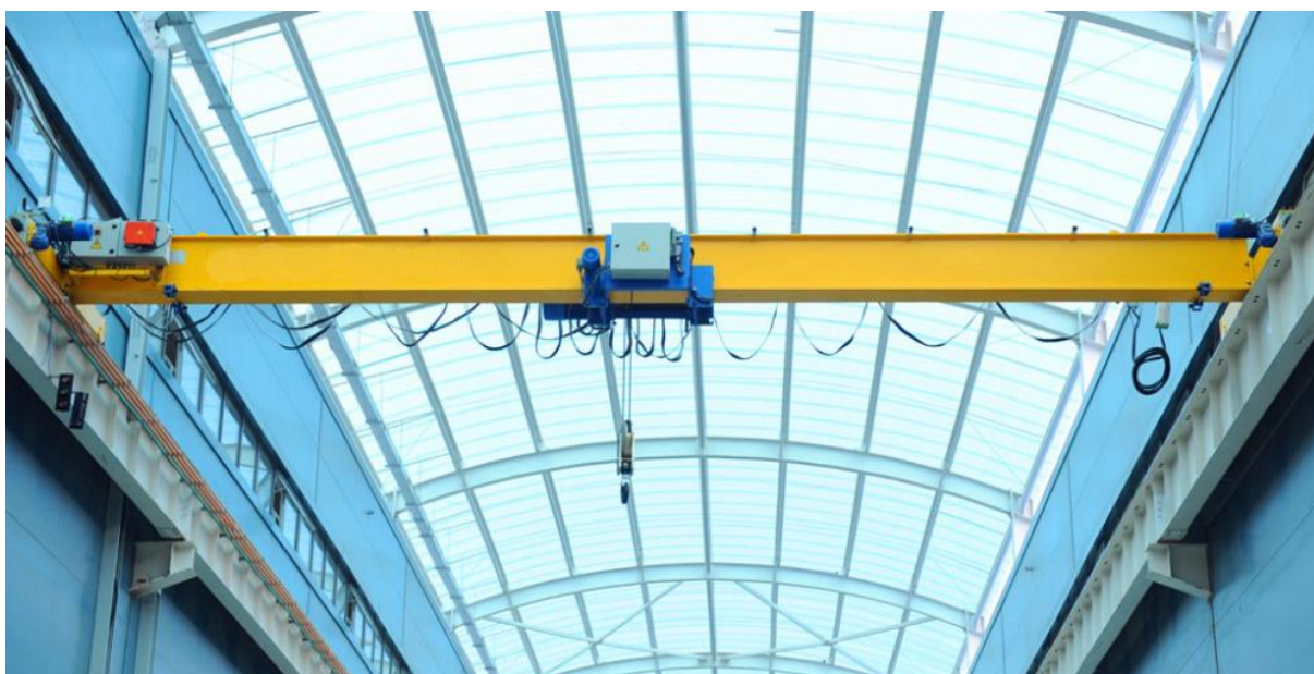
Slika 4. Mosni granik s jednim glavnim nosačem i ovjesnim vitlom [5]
