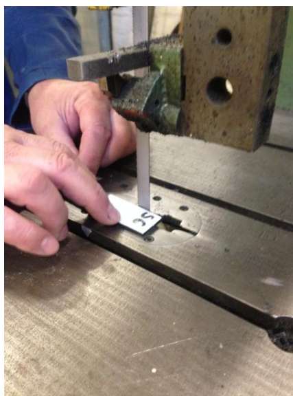
Slika 51. Izrada epruvete za ispitivanje smične čvrstoće
