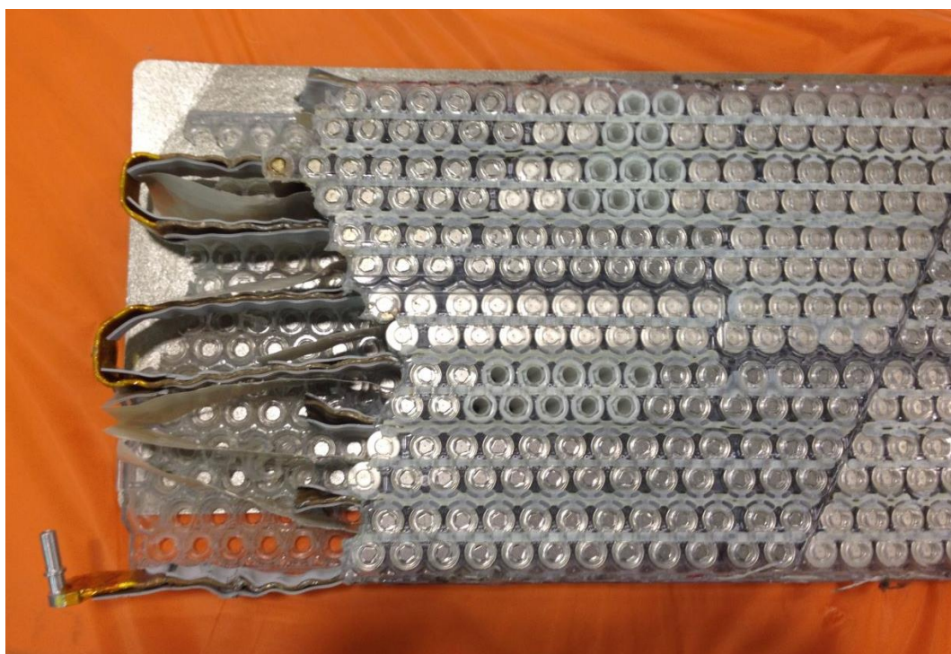
Slika 38. Baterijski paket Tesla P85 s hlađenjem
