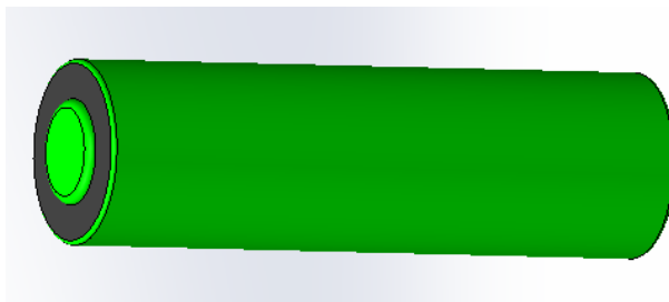
Slika 43. CAD model cilindrične ćelije 21700
