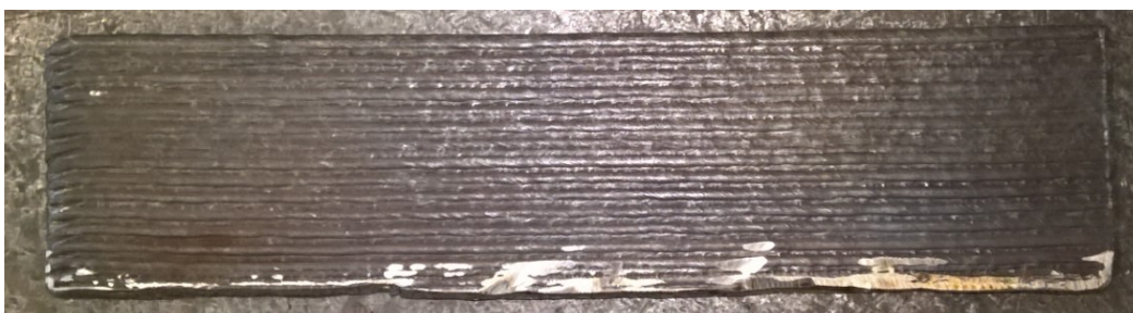
Slika 57. Odrezani zid s podloge za navarivanje
