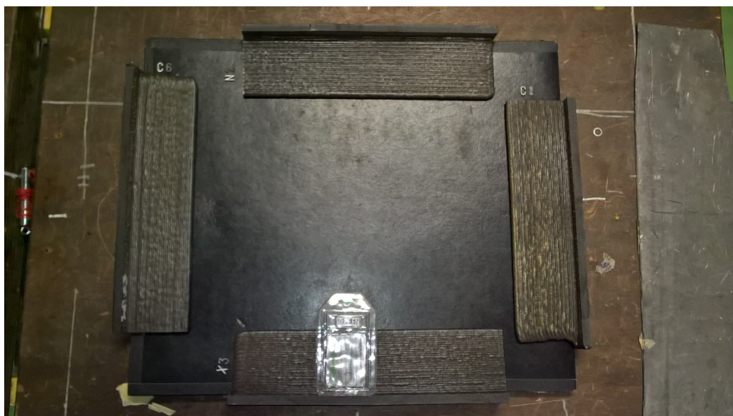
Slika 62. Postav uzoraka za radiografsko ispitivanje
