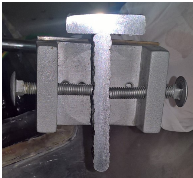
Slika 54. Uzorak pričvršćen u nosaču uređaja za nagrizanje
