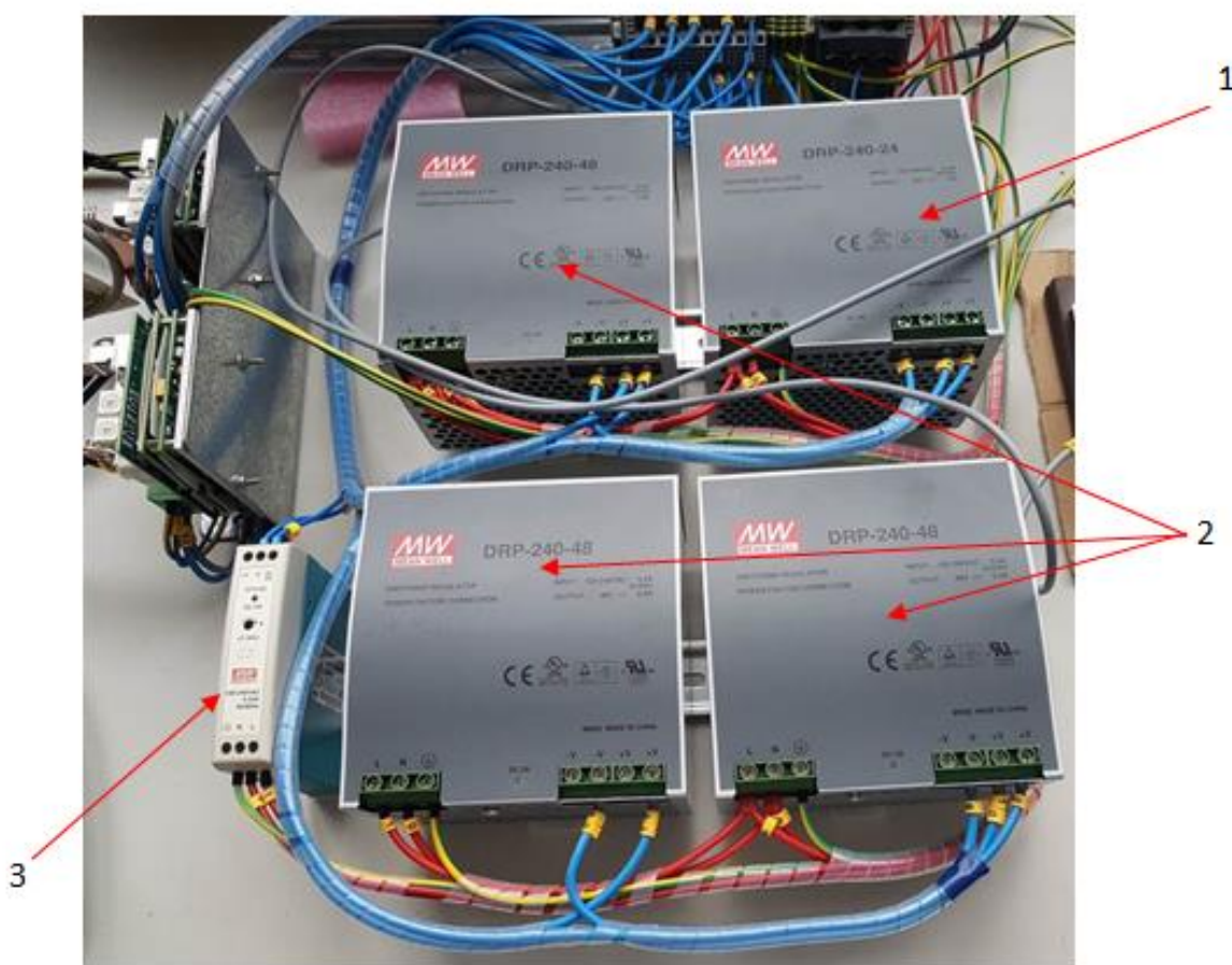
Slika 13. Komponente napajanja (1- DRP-240-24, 2- DRP-240-48, 3- MDR-20-5 )
