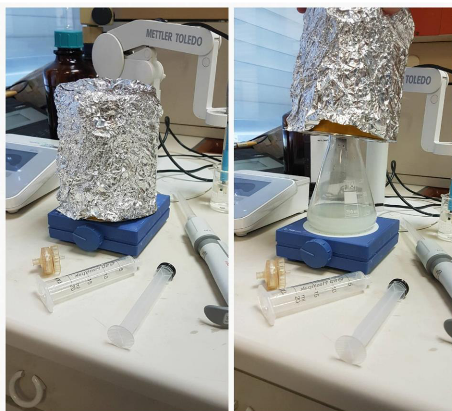
Slika 3.5. Prikaz reaktora za ispitivanje adsorpcije (u mraku) nitrofurantoina na uzorcima TiO_2
